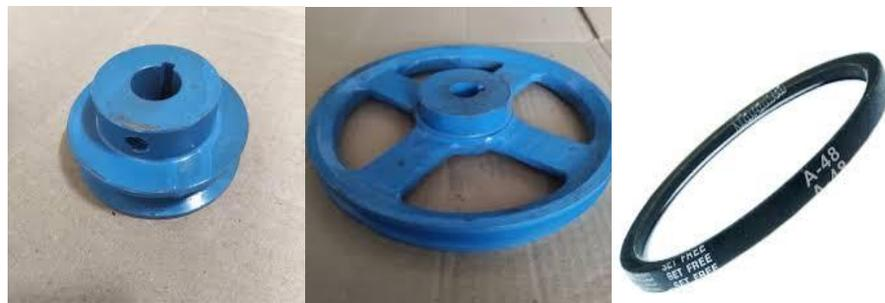
Gambar 3.2 Pulley dan Sabuk-V
