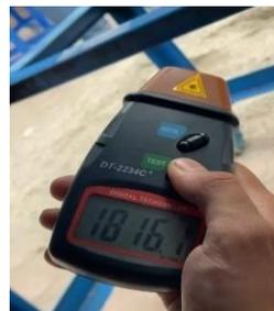
4. Melakukan pengukuran kecepatan putar pulley (N2)
