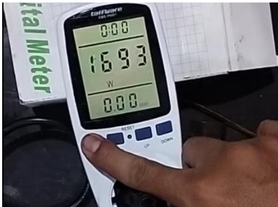
Pengukuran daya listrik
