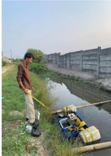
2. Foto pada saat melakukan pengujian mesin oil skimmer tipe drum roller kapasitas 15 liter per jam.
