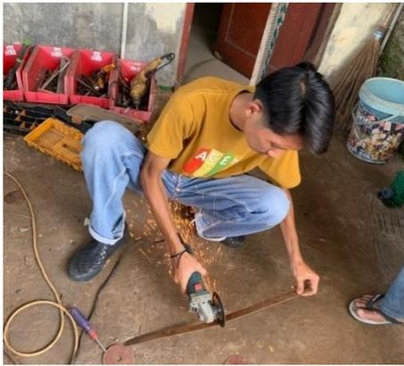
Gambar 4.13 Pemotongan Plat *Strip*
