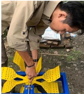
Gambar 4.16 Memasang bantalan pada *inppeller* kincir
