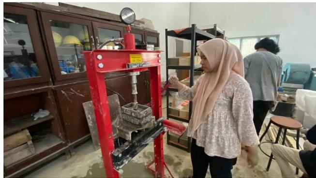
Gambar L.6 : Proses pencetakan bata.
