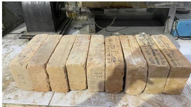
Gambar L.7 : Batu tanah merah dengan campuran serbuk cangkang telur.
