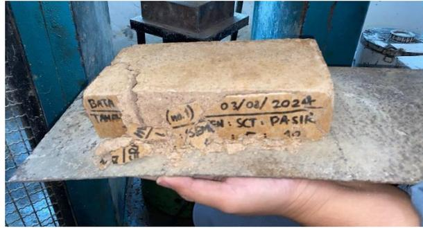
Gambar 4.5: Setelah pengujian kuat tekan.
