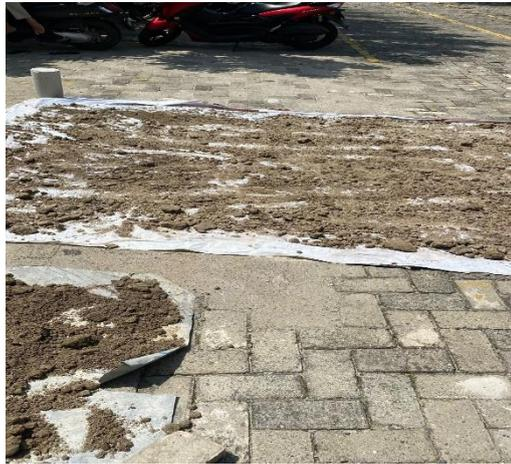
Gambar L.1 : Proses penyakan tanah.
