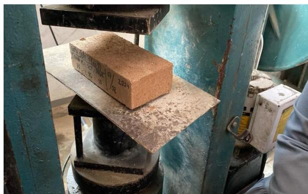
Gambar 4.4: Proses pengujian kuat tekan batu bata.
