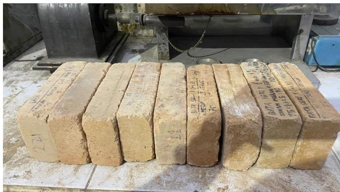
Gambar 4.15: Bata sebelum pengujian kadar garam.
