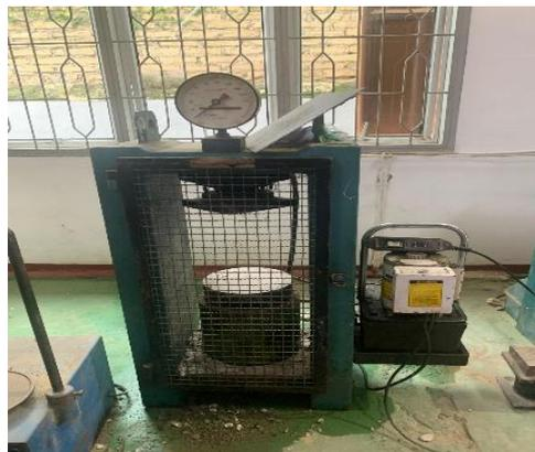
Gambar 3.11 Alat pengujian kuat tekan
