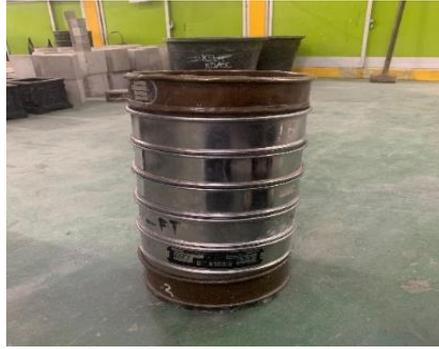
Gambar 3.7 Saringan Agregat Halus
