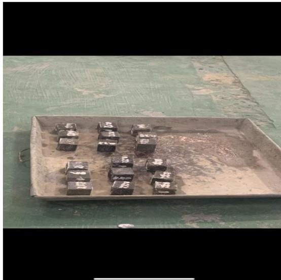
Gambar L 6 : Benda Uji Mortar Setelah Perendaman Selama 28 Hari
