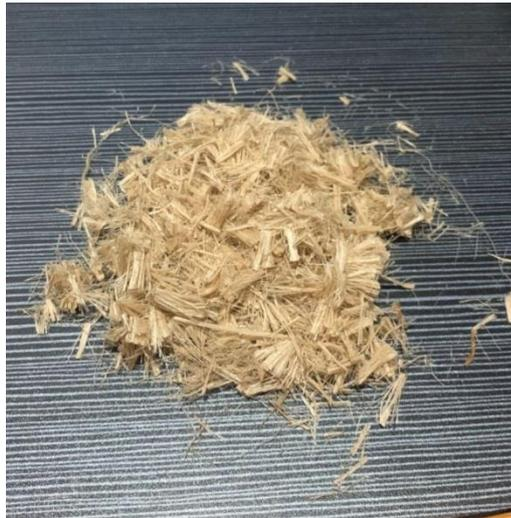
Gambar L 2 : serat batang pisang yang sudah dipotong 5cm untuk campuran mortar
