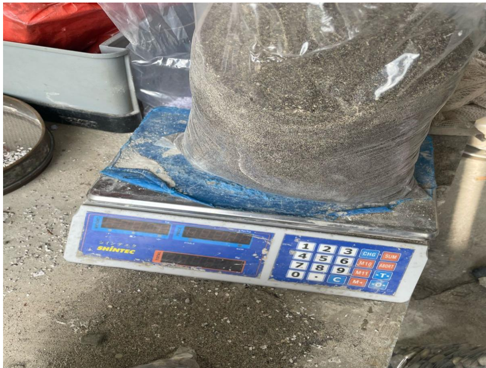
Dokumentasi 4 : penimbangan agregat halus
