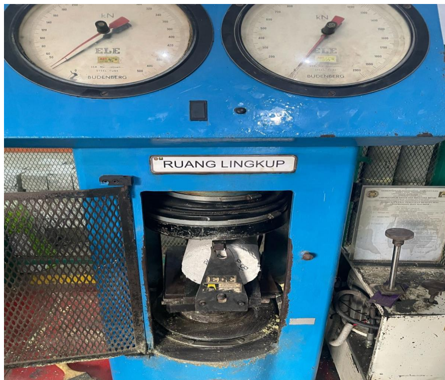
Dokumentasi 9 : Pengujian kuat tarik belah beton
