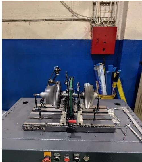
Gambar 3.24 Pengujian *Balancing*
