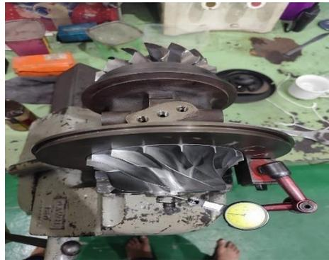
Gambar 4. 35 pengukuran *radial* (PT.WSI)
