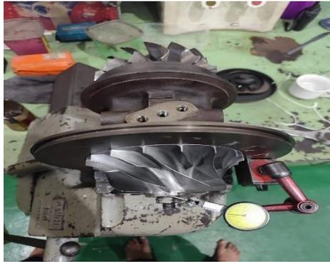
Gambar 4.6 pengukuran *Radial* (PT.WSI)
