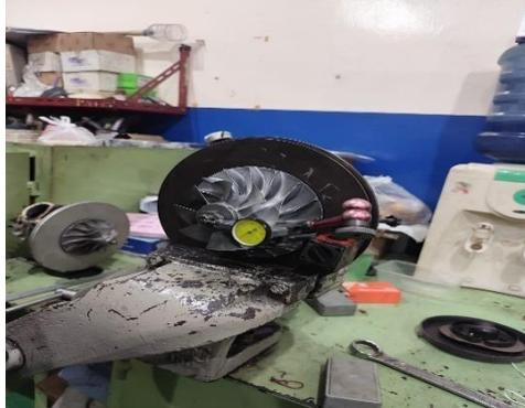
Gambar 4.5 pengukuran *Axial* (PT.WSI)
