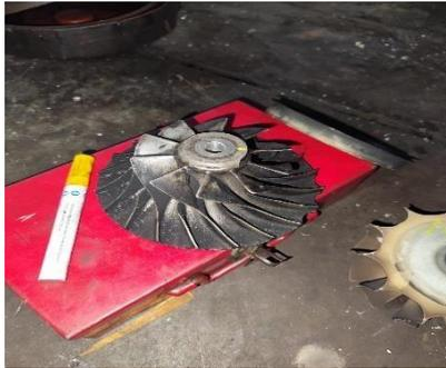
Gambar 4.15 tumpukan kotoran dan *unbalance*
