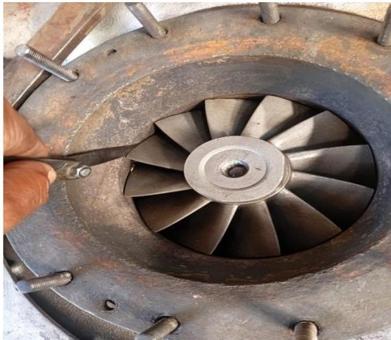
Gambar 4.1 pengukuran *Gap* turbin ( PT.WSI )
