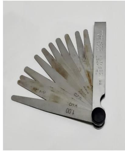
Gambar 3.23 Rancangan *Turbocharger* dan Pengukuran *fuller*
