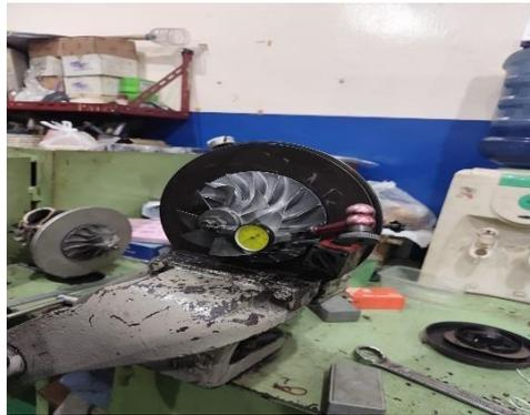
Gambar 4.34 pengukuran *axial* (PT.WSI)
