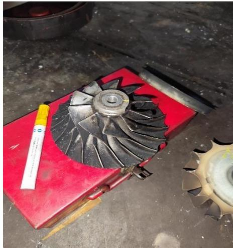
Gambar 4.8 kompresor setelah dibongkar (PT.WSI)
