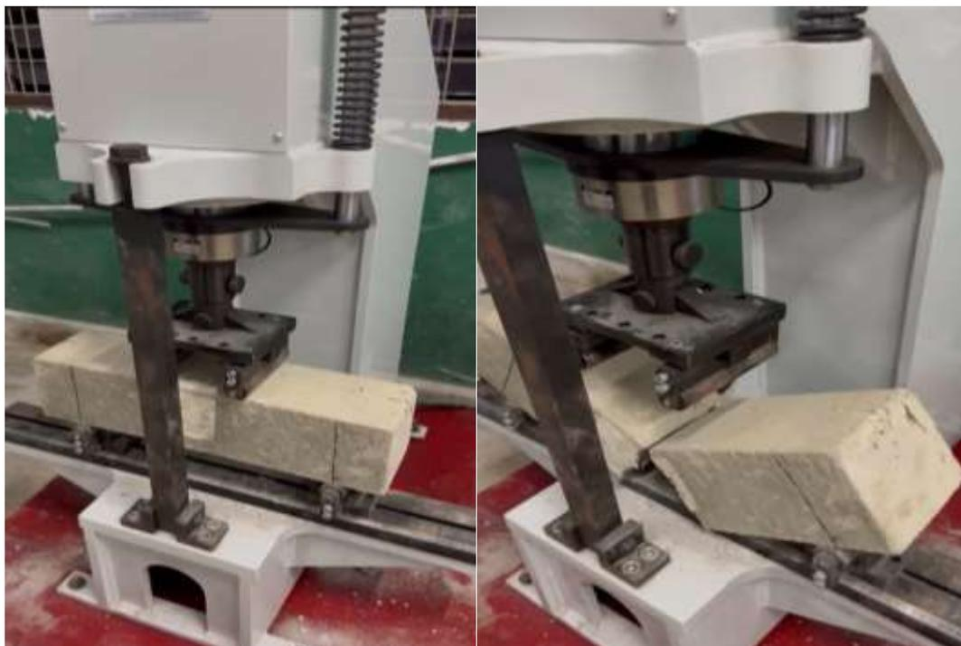
Gambar L.10: Pengujian kuat geser beton.
