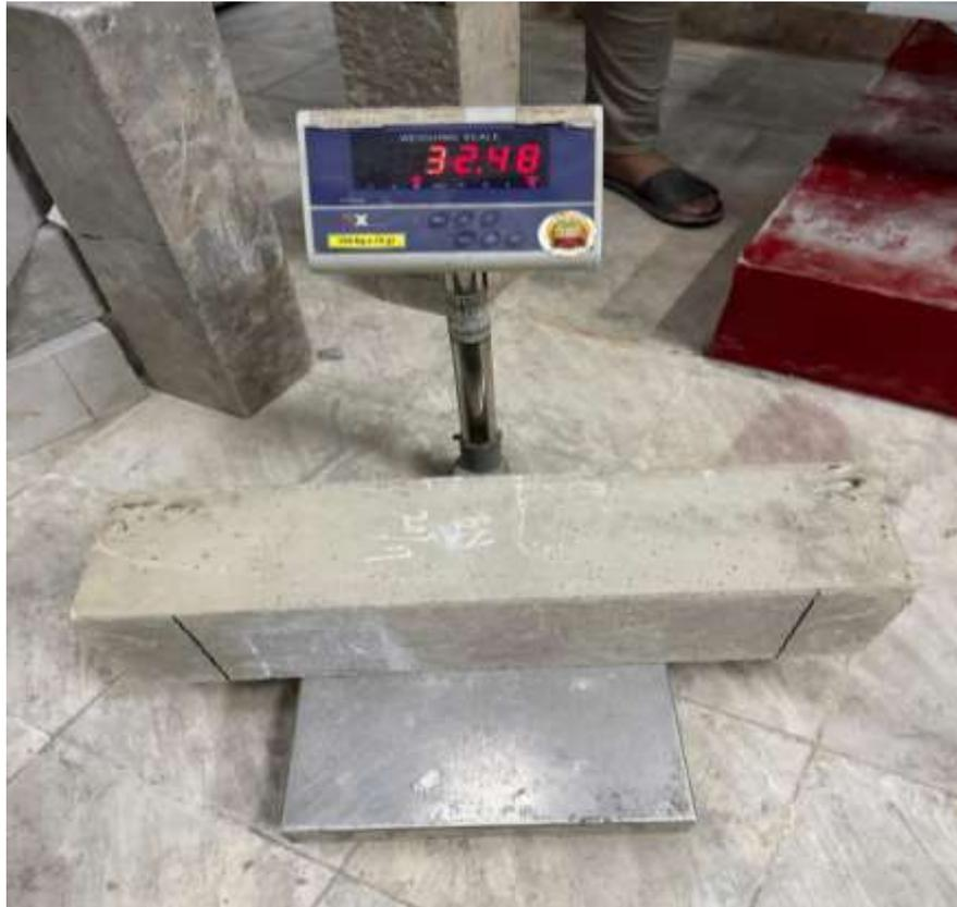
Gambar L.9: Benda uji ditimbang sebelum diuji.
