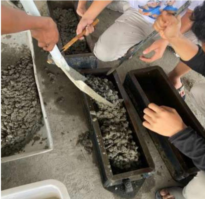
Gambar L.7: Beton segar dimasukkan ke dalam cetakan balok.
