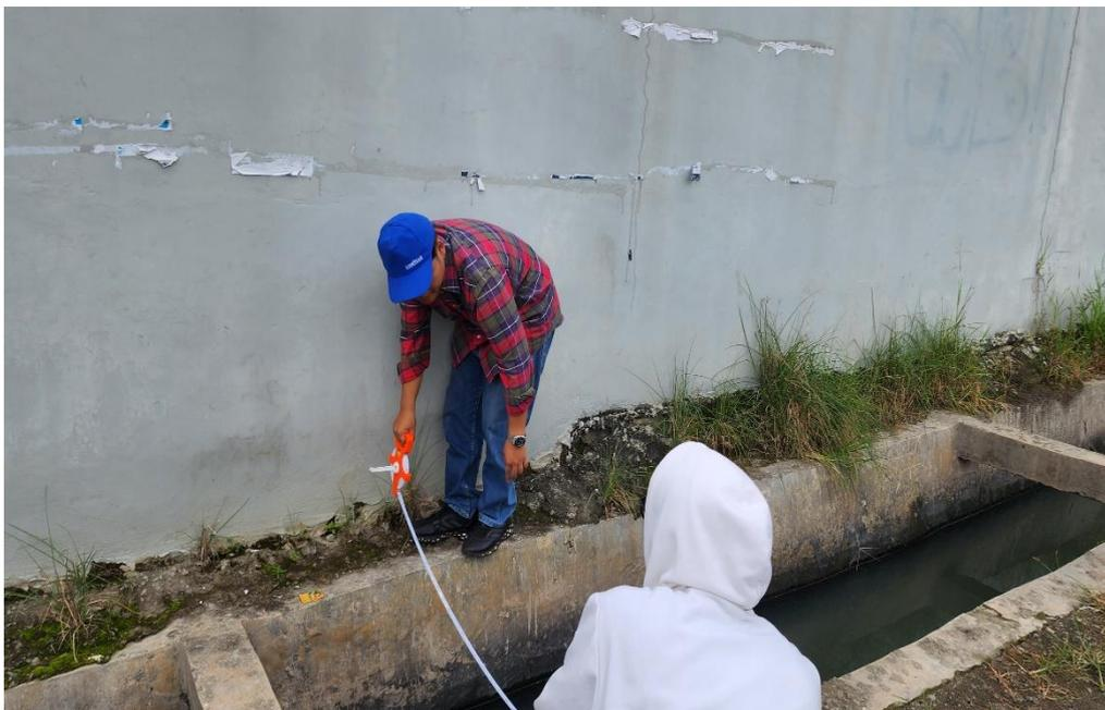
Gambar L. 3 : Pengukuran lebar drainase jalan
