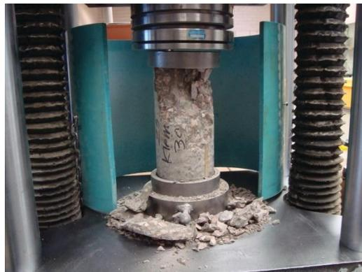
Gambar 3.5: Ilustrasi uji kuat tekan beton.
