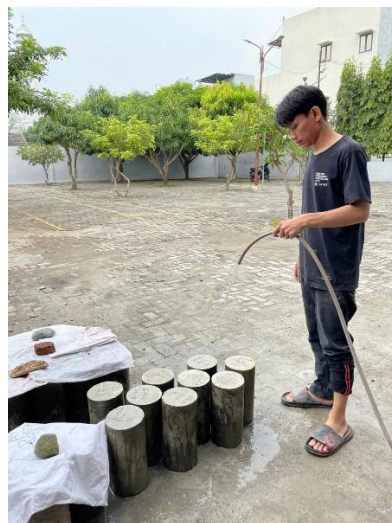
Gambar L-9: Proses melakukan Perawatan Beton
