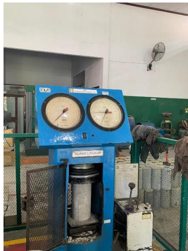
Gambar L-12: Proses Pengujian Kuat Tekan
