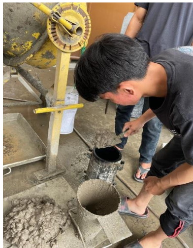
Gambar L-8: Proses Memasukkan Benda Uji ke Cetakan Silinder
