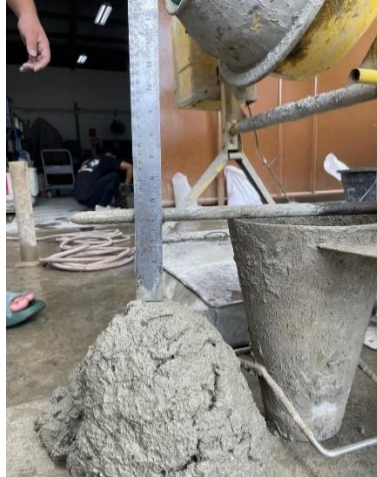
Gambar L-7: Pengecekan Nilai Slump
