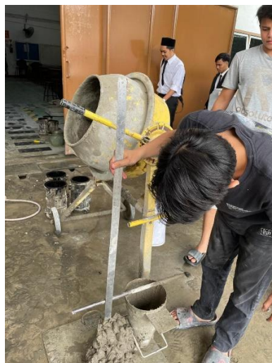
Gambar L-6: Pengukuran Nilai Slump
