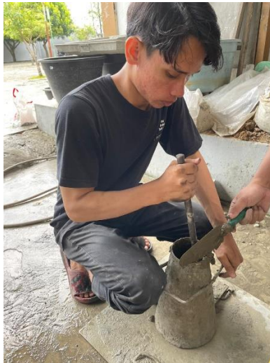
Gambar L-5: Proses Memasukkan Benda Uji ke Kerucut Abrams
