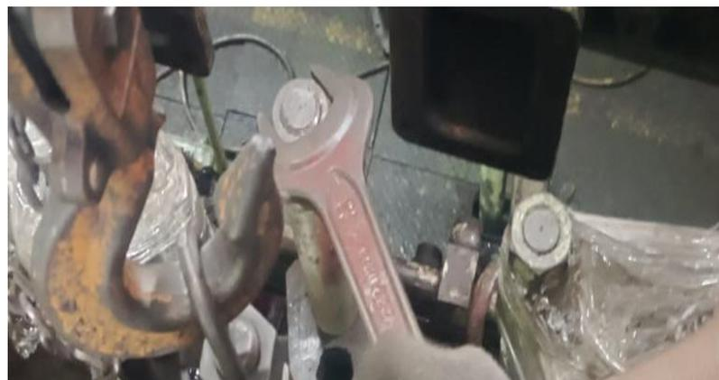
Gambar 4.6 Lepaskan Baut *Cylinder Head*
