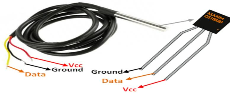
Gambar 2. 7 Sensor Suhu DS18B20 (Salimun Thoha et al., 2021)
