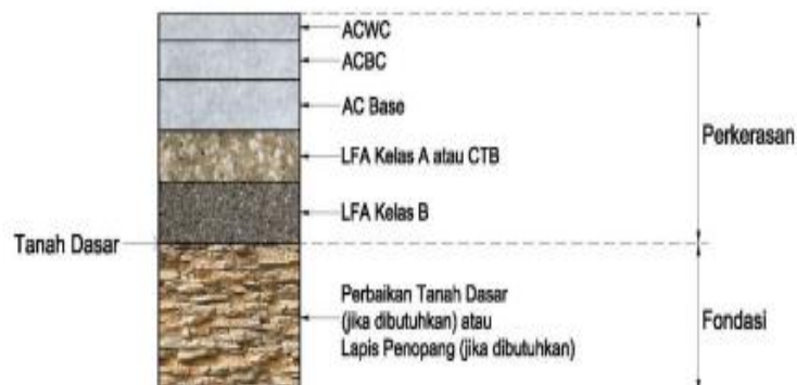
Gambar 2.1 : Struktur Perkerasan Lentur ( Flexible Pavement ) (Manual Desain Perkerasan Jalan 2017)
