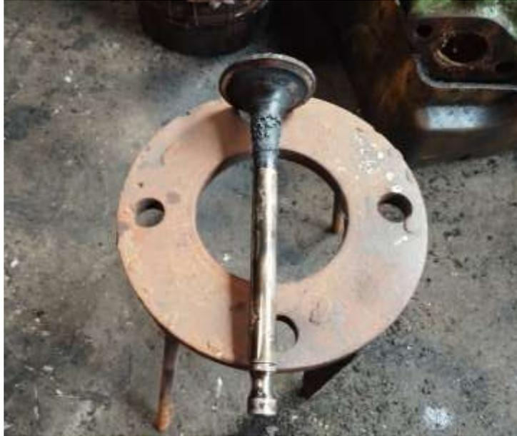
Gambar 2.5 Katup (*Valve*) Mesin *Diesel*
