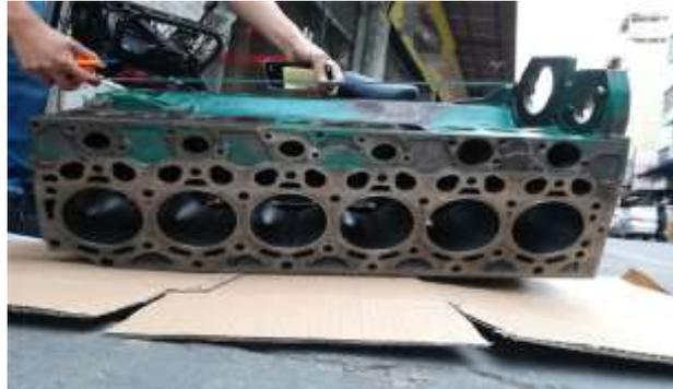
Gambar 2.3 *Cylinder Blok Mesin Diesel*
