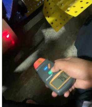
Gambar 4.3 Pada Kecepatan 79,5 RPM (Sumber Dokumentasi Pribadi)
