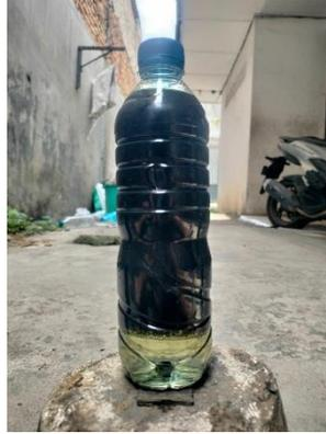
Gambar 4.6 Rasio Minyak dan Air Pada 78,5 RPM (Sumber Dokumentasi Pribadi)
