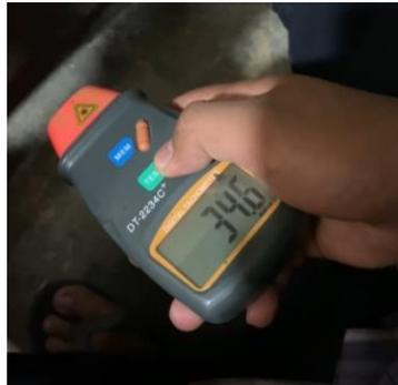
Gambar 3.6 *Tachometer digital* (Sumber Dokumentasi Pribadi)
