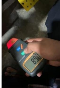
Gambar 4.4 Pada Kecepatan 89,8 RPM (Sumber Dokumentasi Pribadi)
