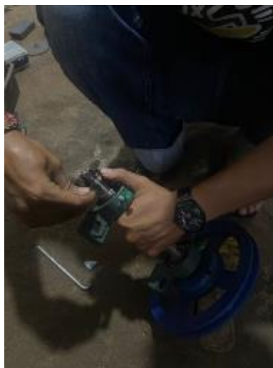
Gambar 4.18 pemasangan gear untuk meneruskan daya ke poros mata pisau
