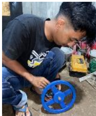
Gambar 4.14 Pemasang pulley pada poros rotor
