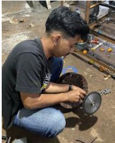
Gambar 4.16 Pemasang sproket pada poros rotor
