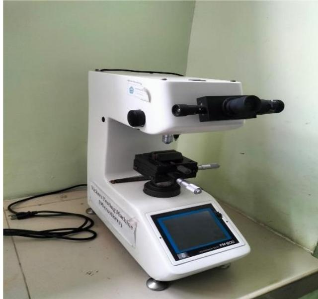
Gambar 2. 4 Alat uji Kekerasan
