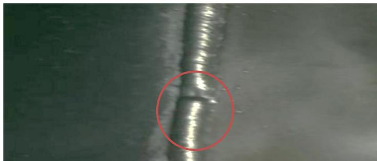
Gambar 4. 2 Cacat undercat dari hasil pengelasan
