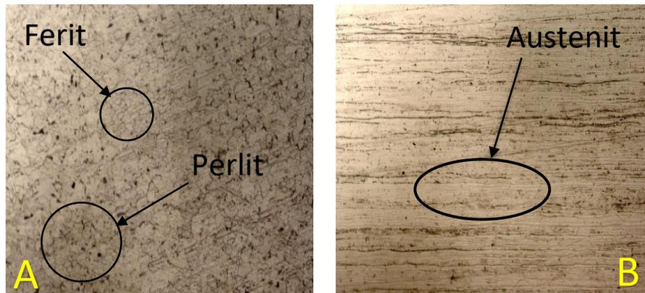
Gambar 4. 3 (a) Base metal baja A36 dan (b) Base metal SS 304
