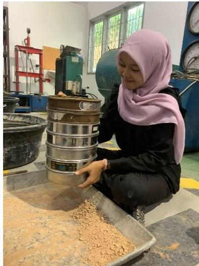
Gambar L-9 Pengujian Analisa Saringan
