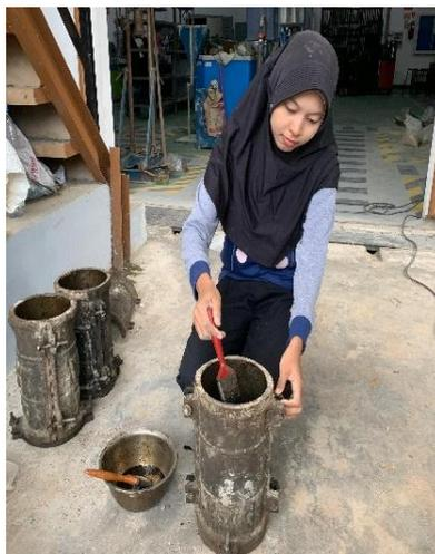
Gambar L-7 Persiapan Cetakan Silinder
