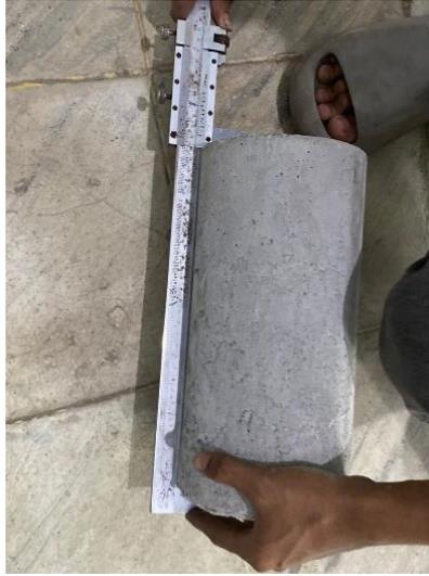
Gambar L-13 Mengukur Tinggi Benda Uji
