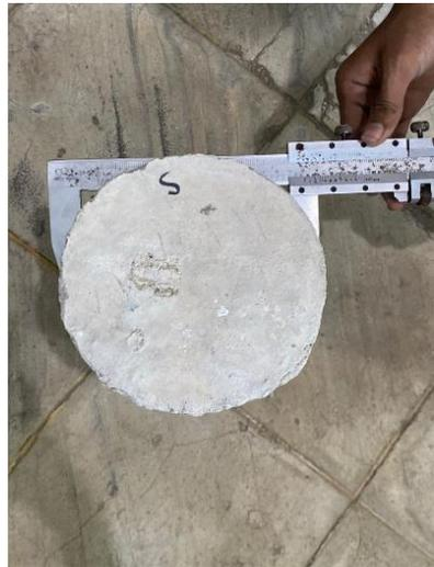
Gambar L-14 Mengukur Diameter Benda Uji
