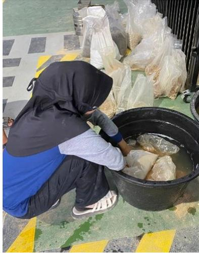
Gambar L-11 Pengujian Kadar Lumpur
