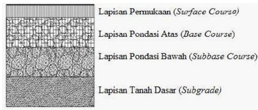
Gambar 2.1: Susunan lapis kontruksi perkerasan lentur (Departemen Pekerjaan Umum Bina Marga, 1987).
