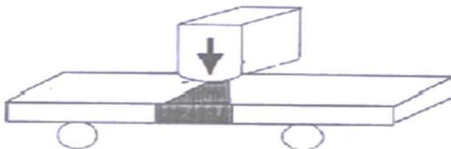
Gambar 2. 11 *Side Bend* pada Transversal Bending.
