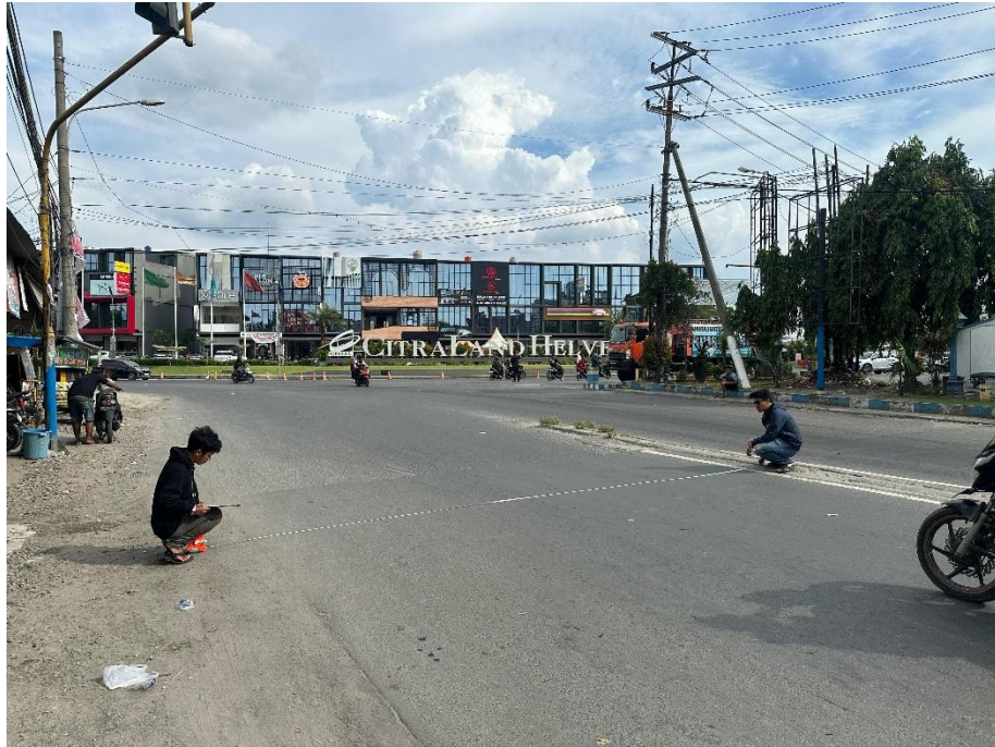
Gambar L 3 : Mengukur Lebar Jalan Ruas Jl.Veteran
