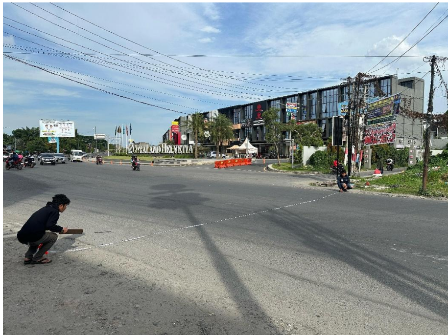
Gambar L 2 : Mengukur Lebar Jalan Ruas Jl.Helvetia
