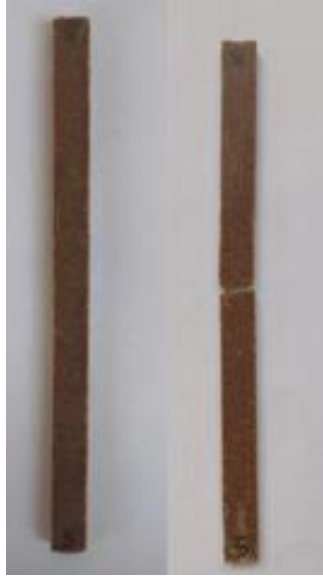
Gambar 4.6 Spesimen sebelum dan sesudah pengujian bending variasi perlakuan alkali 7 jam perendaman
