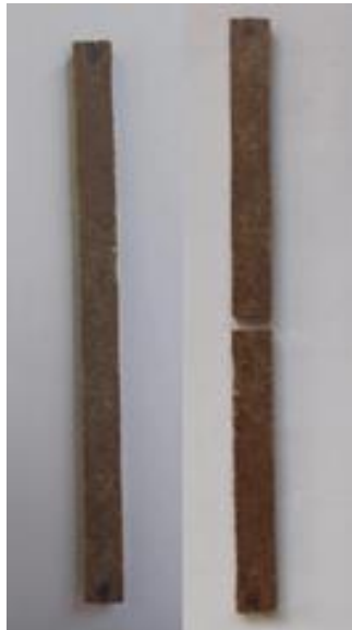
Gambar 4.5 Spesimen sebelum dan sesudah pengujian bending variasi perlakuan alkali 5 jam perendaman
