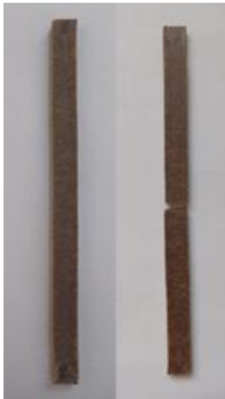
Gambar 4.3 Spesimen sebelum dan sesudah pengujian bending variasi perlakuan alkali 1 jam perendaman.
