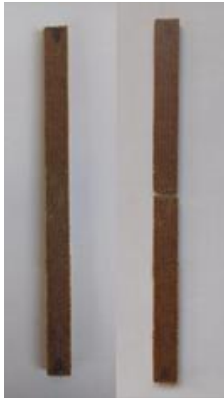
Gambar 4.7 Spesimen sebelum dan sesudah pengujian bending variasi perlakuan alkali 9 jam perendaman
