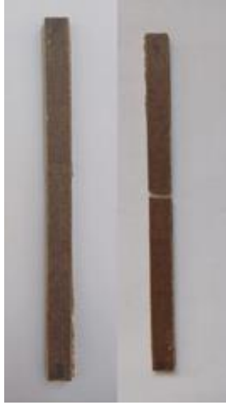
Gambar 4.4 Spesimen sebelum dan sesudah pengujian bending variasi perlakuan alkali 3 jam perendaman
