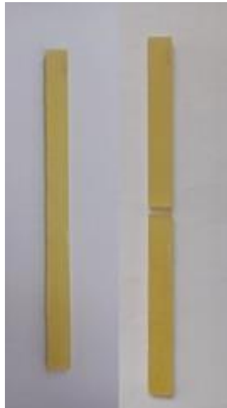
Gambar 4.1 Spesimen sebelum dan sesudah pengujian bending variasi spesimen tanpa serat (TS)
