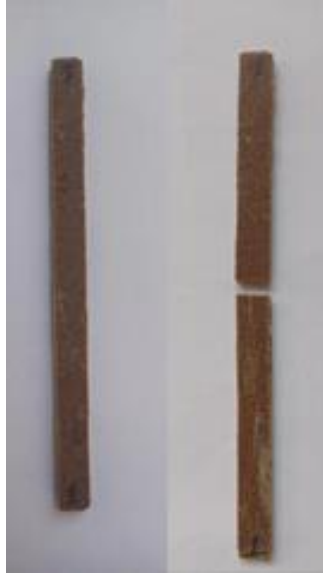
Gambar 4.2 Spesimen sebelum dan sesudah pengujian bending variasi tanpa perlakuan larutan alkali (TP)
