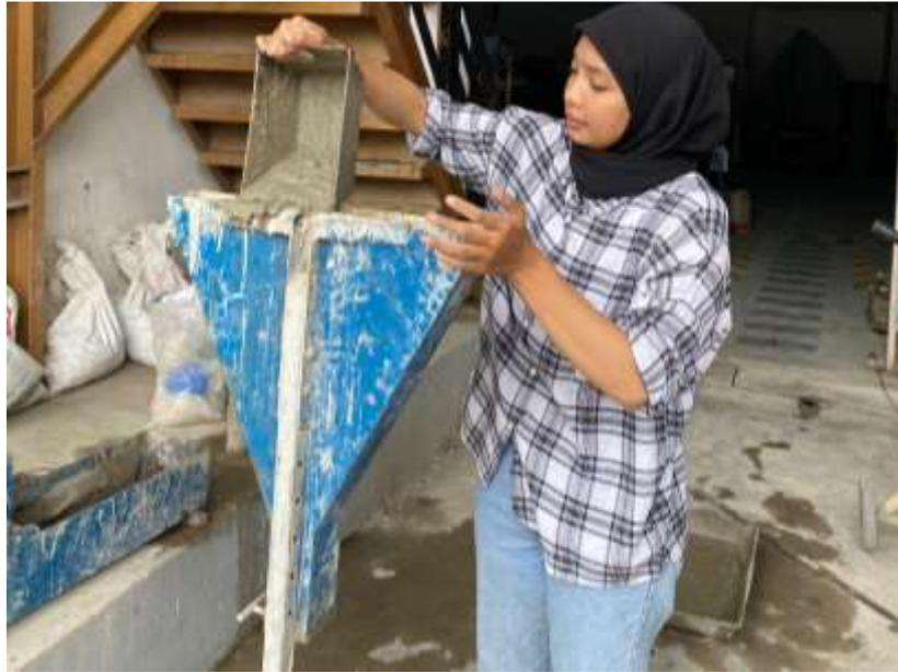
Gambar L. 3 Melakukan Pengujian V Funnel Test pada Beton Segar
