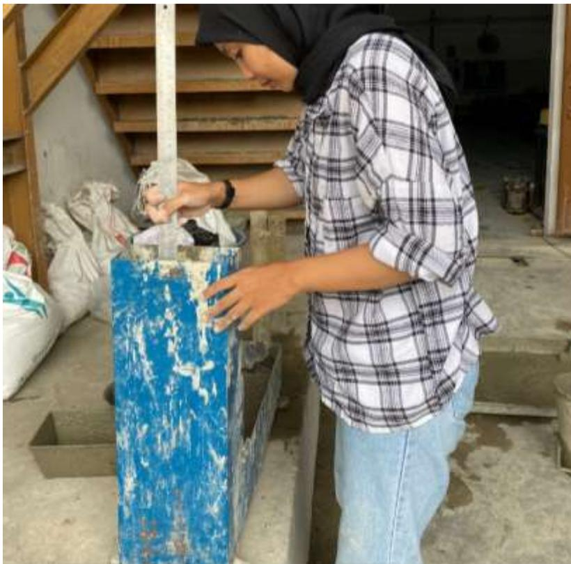
Gambar L. 4: Melakukan Pengujian L – Box Test pada Beton Segar
