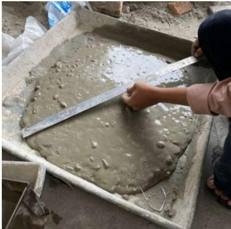
Gambar L. 2 Melakukan Pengujian *Slum Flow* test pada Beton Segar
