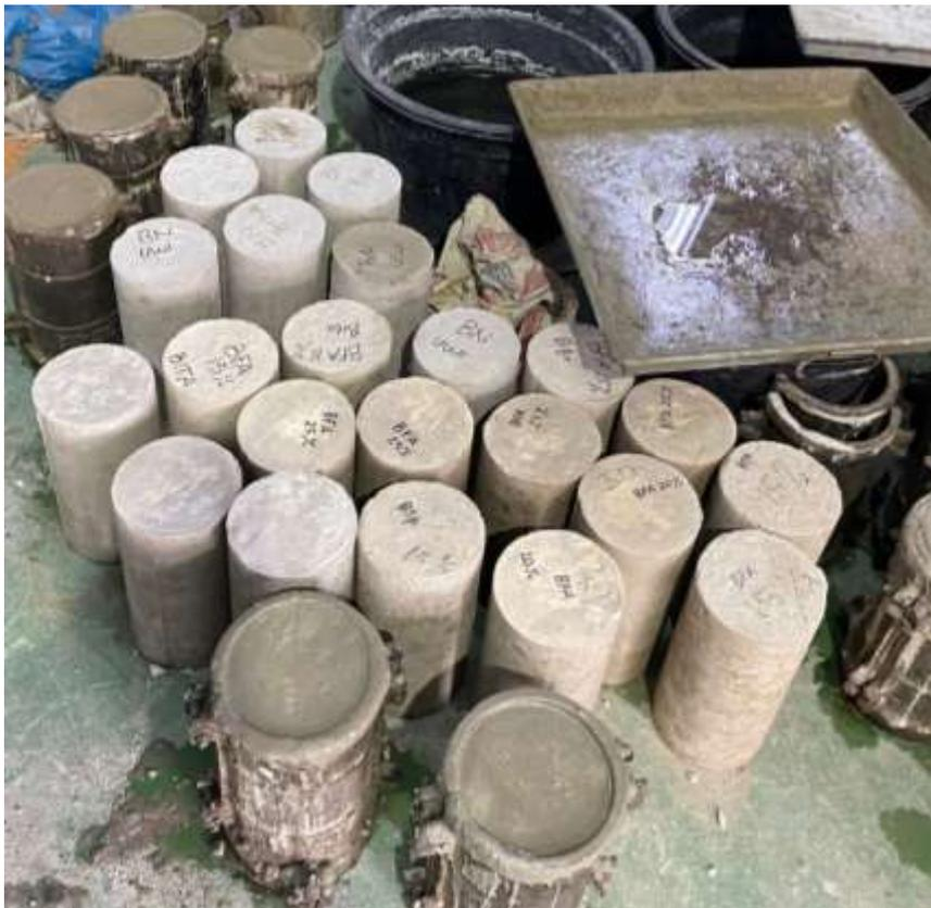
Gambar L.6: Mengeluarkan Beton dari cetakan
