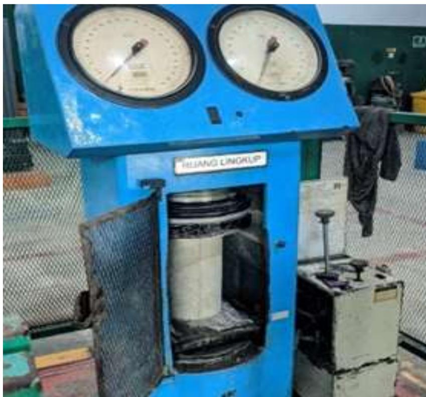
Gambar L. 10: Pengujian Modulus Elastisitas k beton
