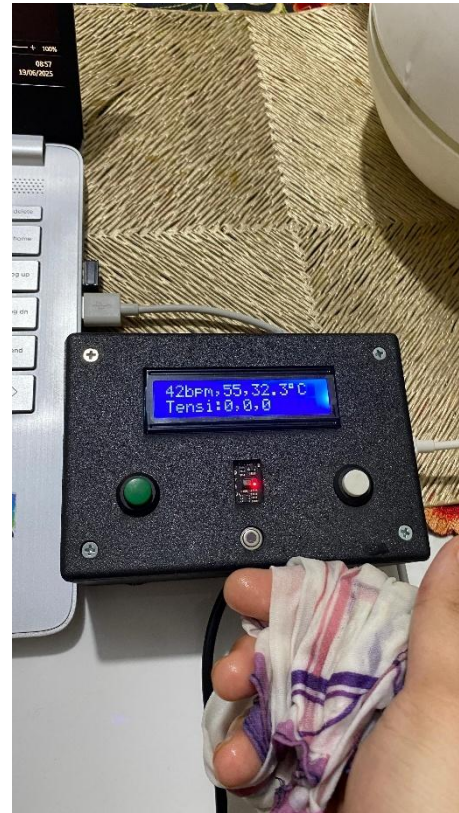
Gambar 4.5 Pengujian MLX90614 Pada Kondisi Suhu Tubuh Normal, Dingin, dan Panas
