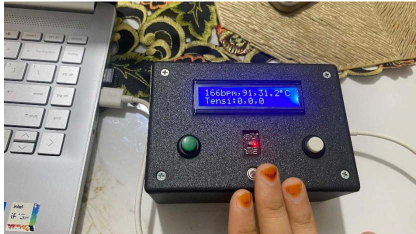
Gambar 4.5 Pengujian MLX90614 Pada Kondisi Suhu Tubuh Normal, Dingin, dan Panas
