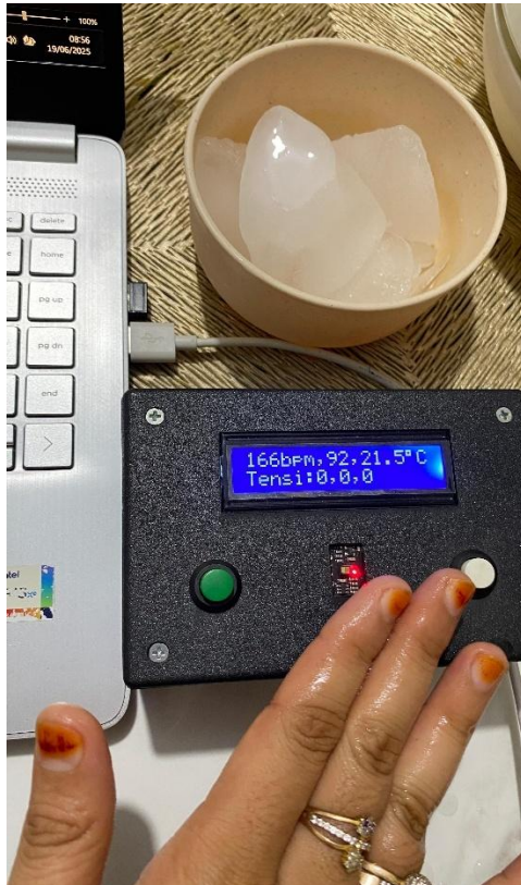
Gambar 4.5 Pengujian MLX90614 Pada Kondisi Suhu Tubuh Normal, Dingin, dan Panas
