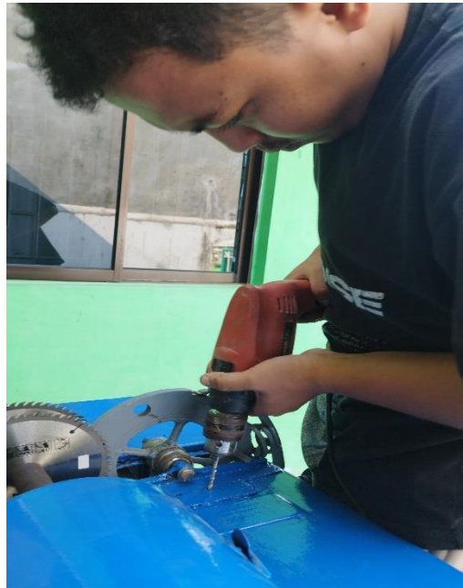
Gambar 4. 11 Proses Pengeboran lubang baut
