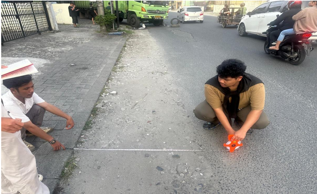
Gambar L 3 : Pengukuran bahu jalan
