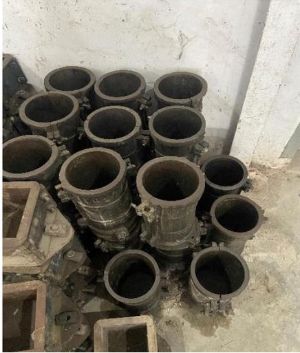
Gambar L.1.7 Cetakan Silinder
