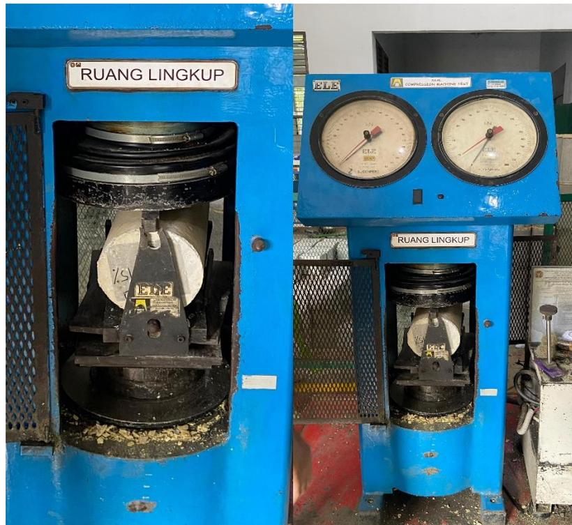
Gambar L.3.1 Proses Pengujian Kuat Tarik Belah Beton
