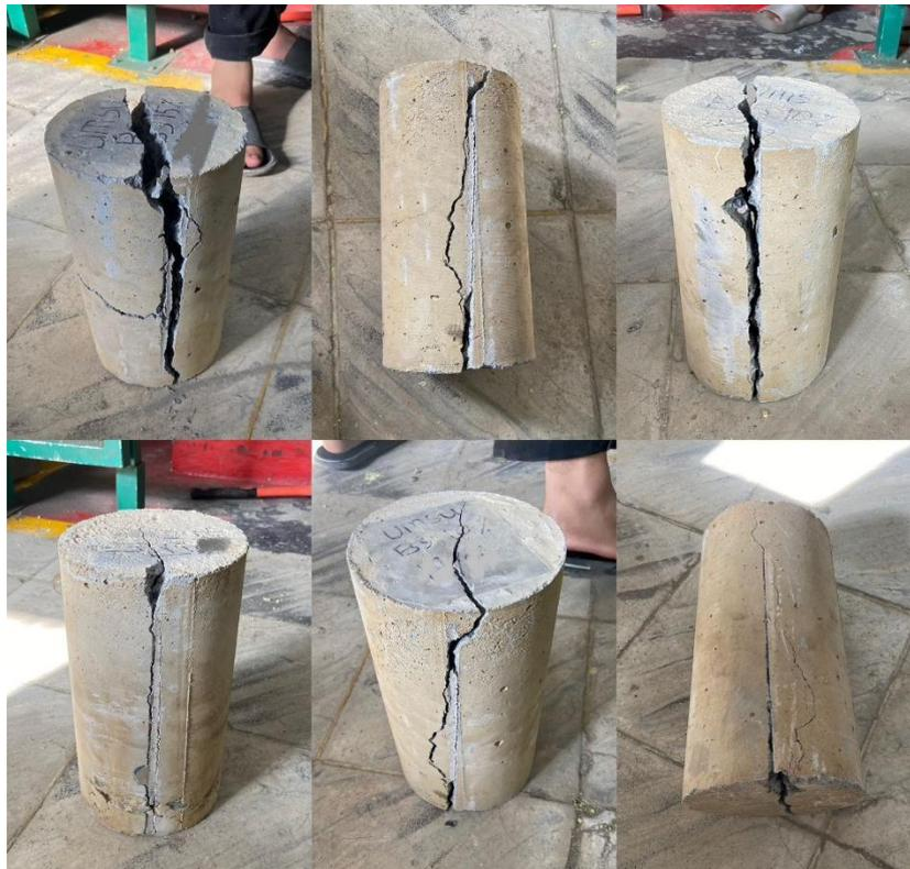
Gambar L.3.2 Hasil Pengujian Kuat Tarik Belah Beton
