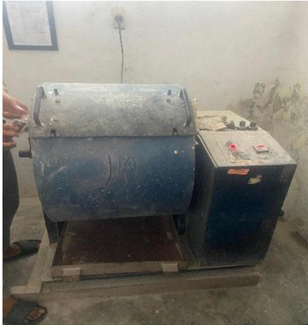
Gambar L.1.1 Mesin Abrasi
