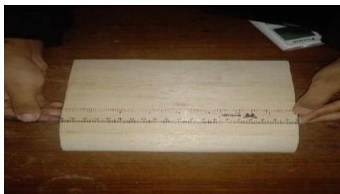
Gambar 3.9 Hasil jadi dari airfoil NACA 0018
