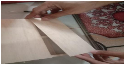
Gambar 3.8 Proses penempelan kayu balsa pada rangka airfoil
