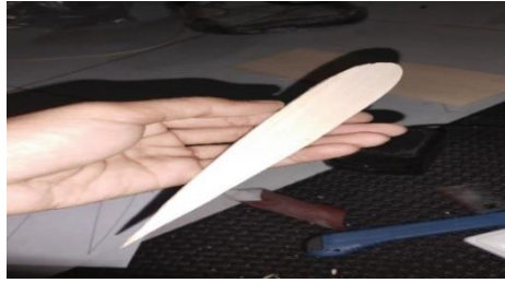
Gambar 3.6 Bentuk airfoil NACA 0018 pada kayu balsa
