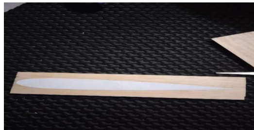
Gambar 3.5 Pemotongan kayu balsa dengan model airfoil NACA 0018
