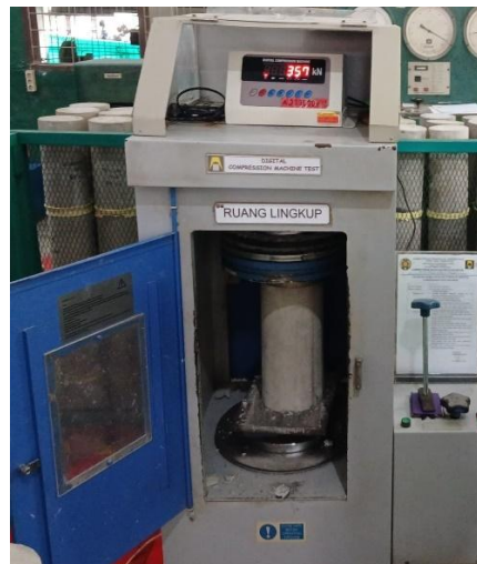
Gambar 3.5: Uji kuat tekan beton.
