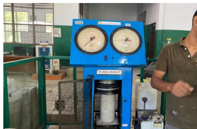
Gambar L-9 Pengujian Kuat Tekan
