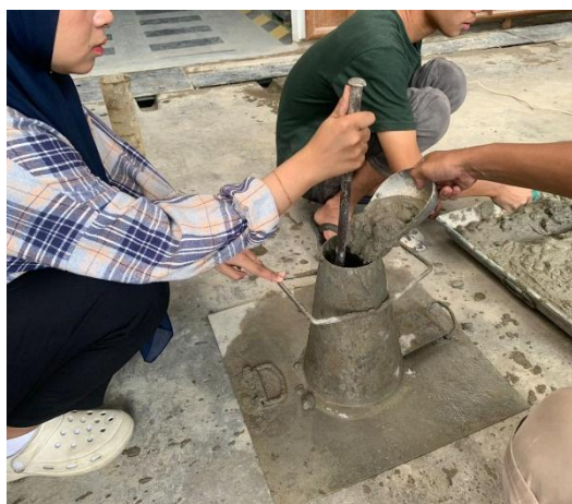
Gambar L-6 Proses Pengujian Slump Test
