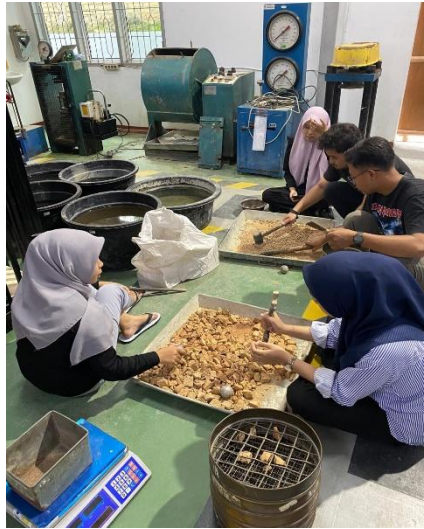
Gambar L-1 Proses Menghancurkan Limbah Bata Tanpa Bakar
