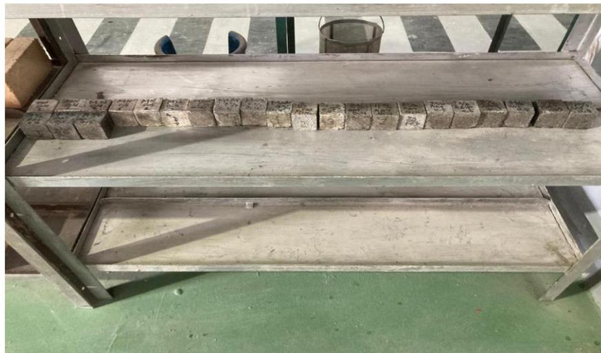
L17: Benda uji mortar keluar dari cetakan
