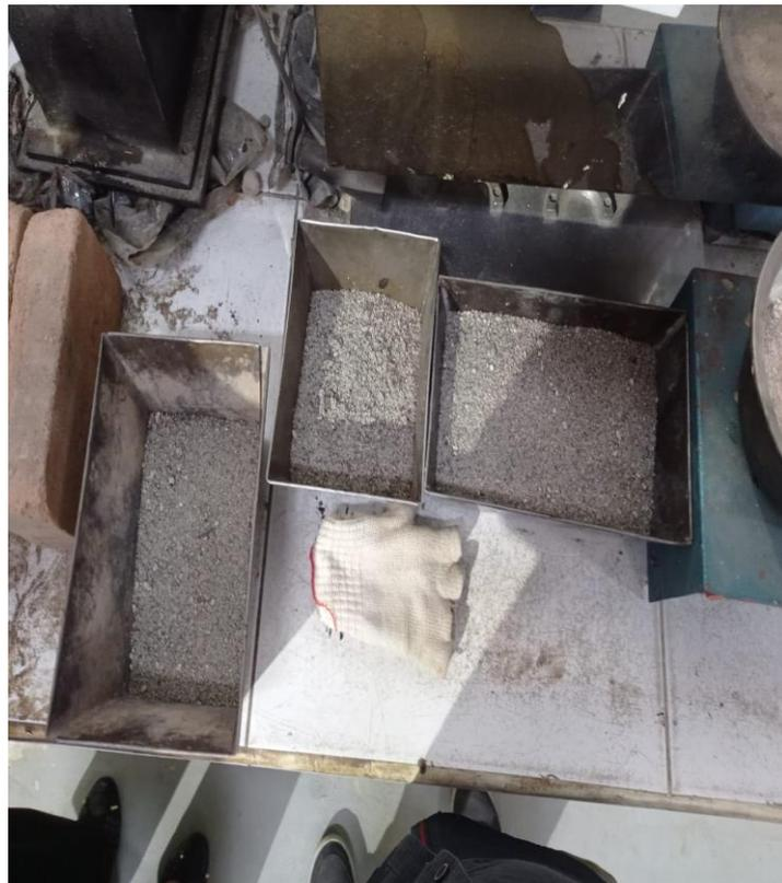
L8: Benda uji agregat halus kering oven
