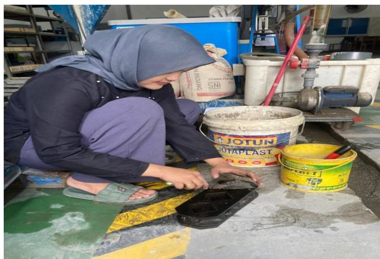
L14: Menuangkan komposisi bahan campuran mortar kedalam cetakan
