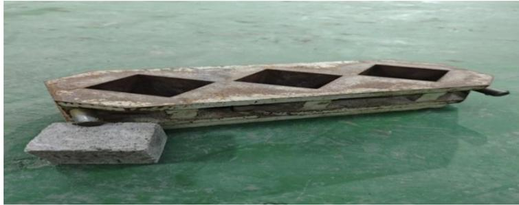
Gambar 3.3 : Benda Uji Kubus Mortar.
