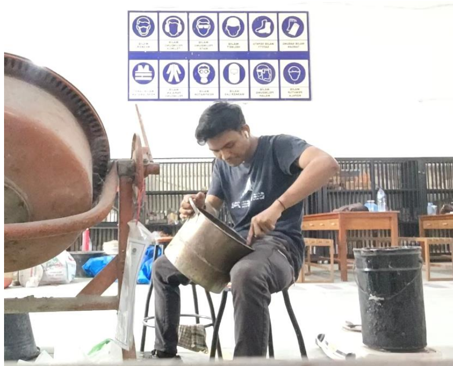
Gambar L13: Proses Pembuatan Benda Uji Mortar
