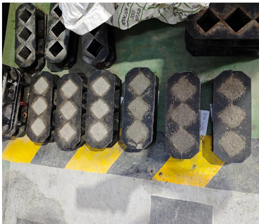
Gambar L14: Benda Uji Mortar Dalam Cetakan
