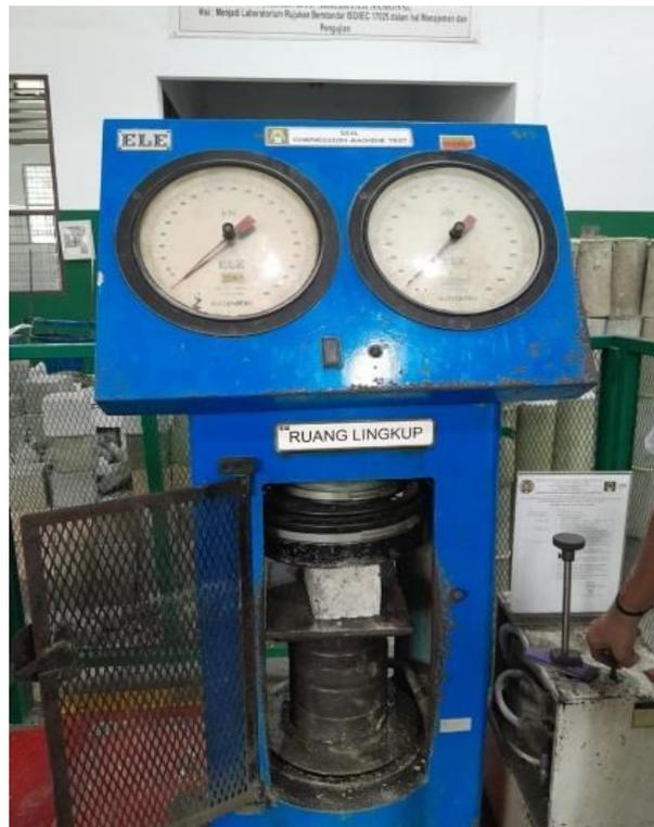
Gambar 3.4: Mesin uji kuat tekan CTM (*Compression Testing Machine*)
