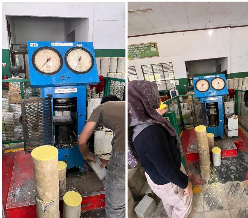
Gambar L7 : Proses pengujian dengan mesin compression testing machine
