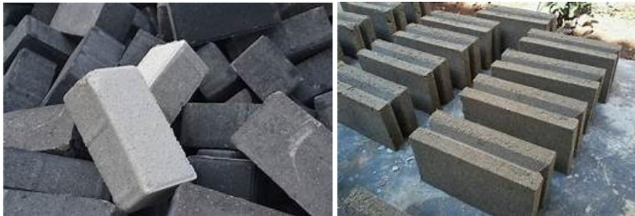
Gambar 2.1 : Bata beton pejal/padat
