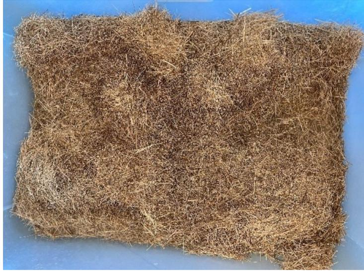
Gambar L3: Serabut kelapa benda uji
