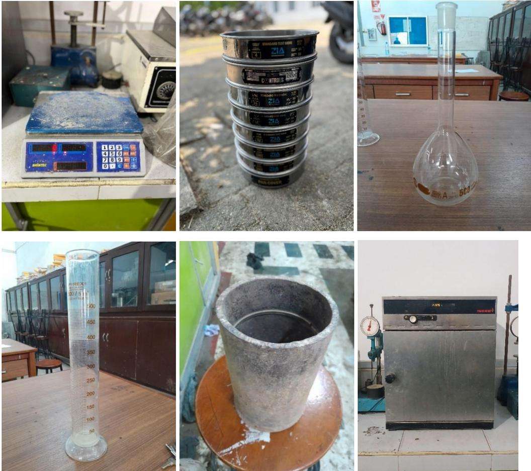
Gambar L1: Peralatan pengujian agregat halus
