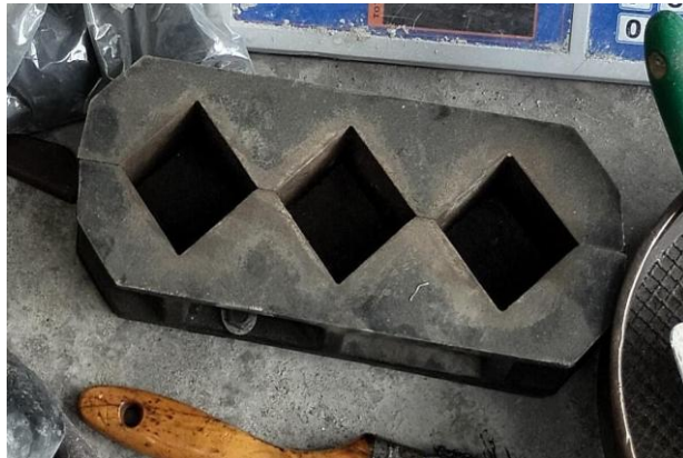
Gambar 3.18 : Cetakan Benda Uji Berbentuk Kubus 5cm x 5cm 5cm
