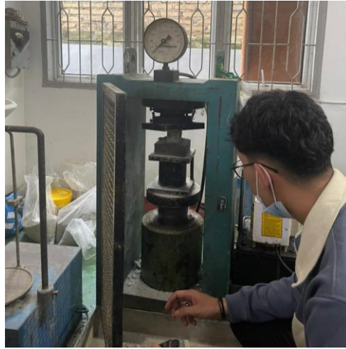
Gambar L.7 Pengujian Kuat Tekan Mortar
