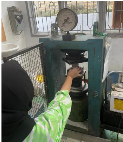
Gambar L.8 Pengujian Kuat Tekan Mortar
