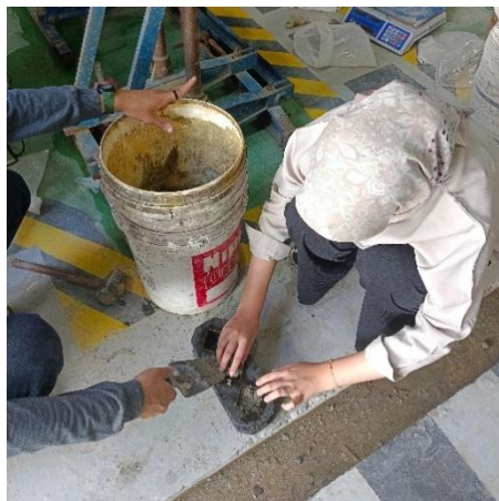
Gambar L.5 Pembuatan Benda Uji Mortar
