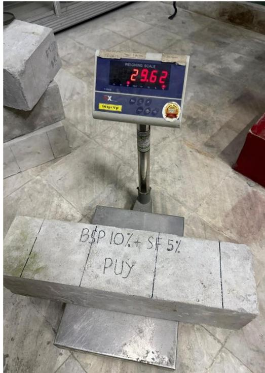
Gambar L.5: Benda uji ditimbang sebelum diuji.
