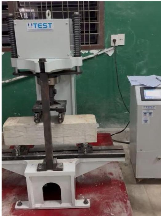
Gambar L.6: Pengujian kuat geser beton.
