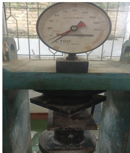
Gambar L.21 Hasil Uji Kuat Tekan Mortar Fly Ash 25%
