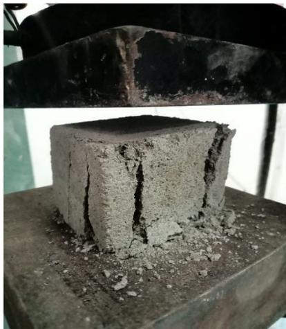
Gambar L. 11 Pengujian Kuat Tekan Mortar Fly Ash 25 %
