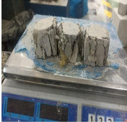
Gambar L. 13 Pengujian Kuat Tekan Mortar Fly Ash 25 % Serat Buah Pinang
