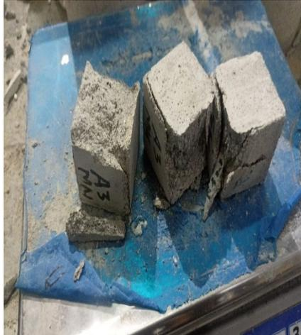
Gambar L. 7 Pengujian Kuat Tekan Mortar Normal
