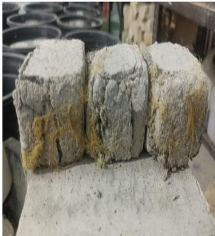
Gambar L.15 Pengujian Kuat Tekan Mortar Fly Ash 25 % Serat Buah Pinang
