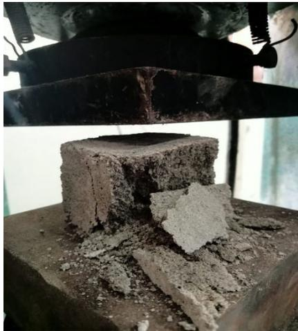
Gambar L. 8 Pengujian Kuat Tekan Mortar Fly Ash 10 %
