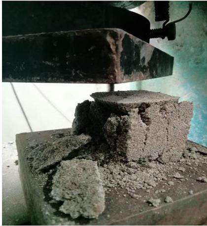
Gambar L. 10 Pengujian Kuat Tekan Mortar Fly Ash 20%
