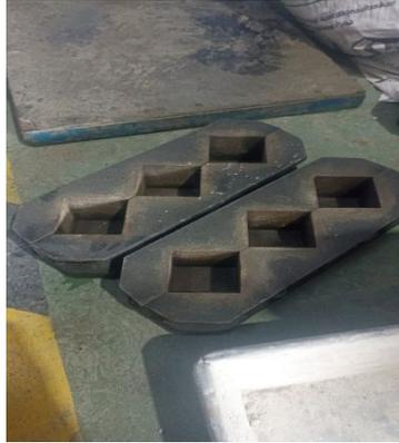
Gambar 3.14 : Cetakan mortar
