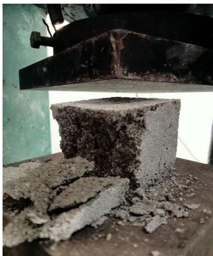
Gambar L. 9 Pengujian Kuat Tekan Mortar Fly Ash 15 %
