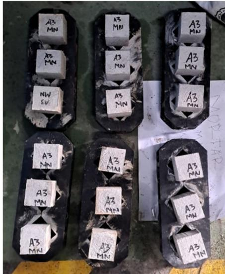
Gambar 2.4 : Mortar dengan cetakan 5x5x5 cm
