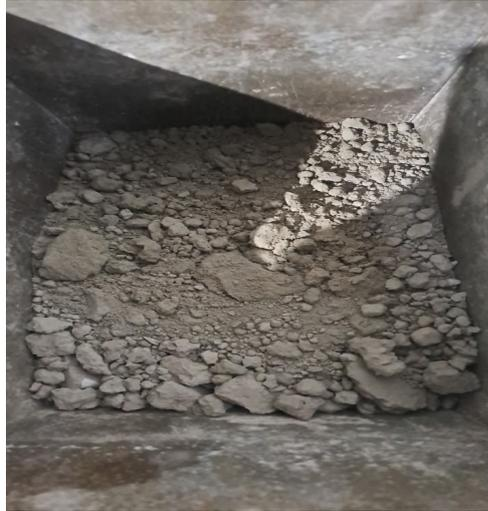
Gambar 3.5 : Fly ash yang digunakan untuk penelitian
