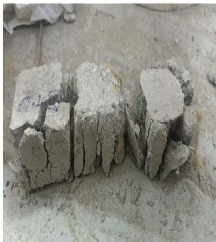
Gambar L.12 Pengujian Kuat Tekan Mortar Fly Ash 25 % Serat Buah Pinang 0,25%
