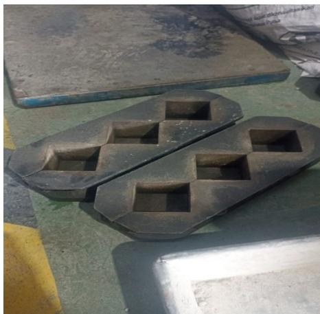
Gambar L. 4 Cetakan Mortar
