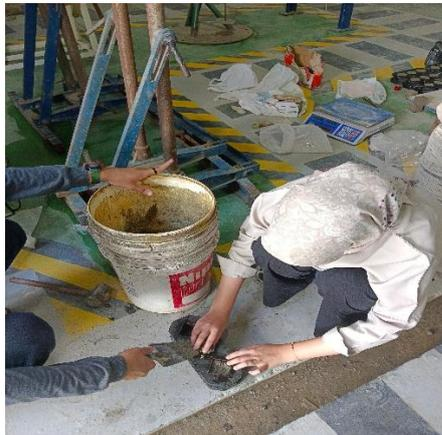
Gambar 3. 44 Menuangkan adonan mortar kedalam cetakan kubus
