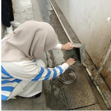
Gambar L.4 Pengujian Kadar Lumpur Agregat Halus
