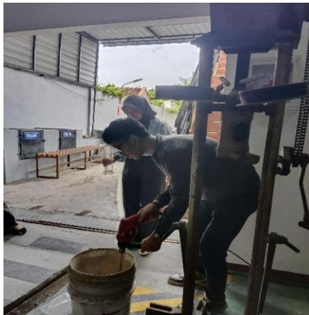
Gambar 3. 53 Mengaduk semua bahan menggunakan mesin bor
