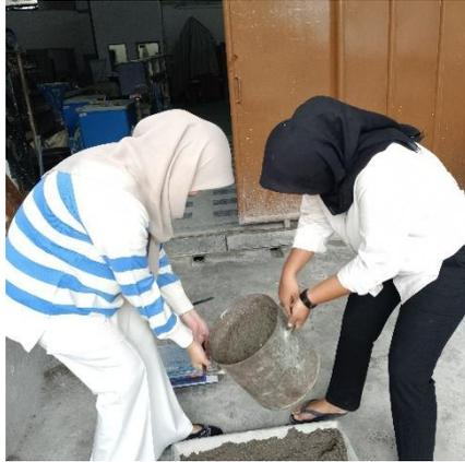
Gambar L.1 Pengujian Berat isi Agregat Halus
