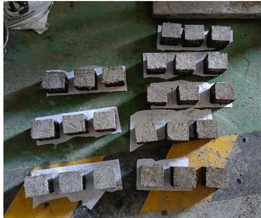
Gambar 3. 63 Memastikan benda uji kering sempurna
