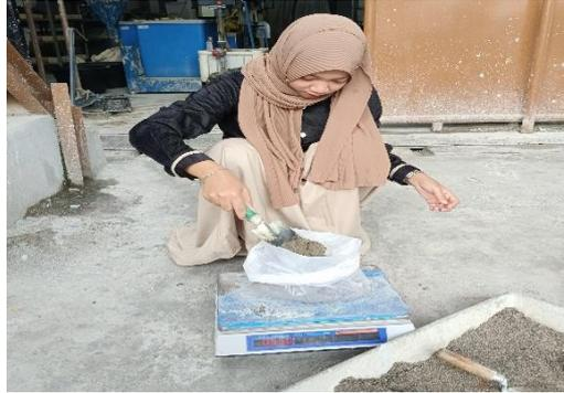
Gambar 3. 4 Menimbang agregat halus
