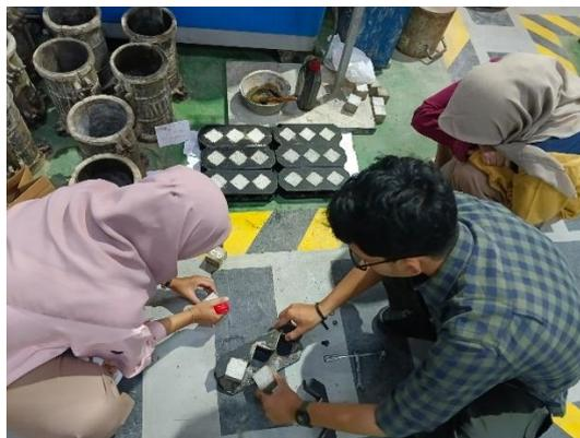
Gambar 3. 62 Mengeluarkan benda uji dari cetakan
