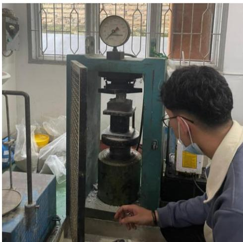
Gambar L.7 Pengujian Kuat Tekan Mortar
