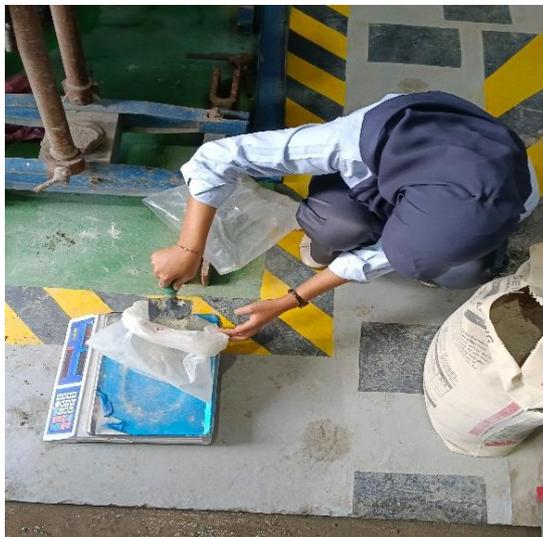
Gambar 3. 51 Menimbang bahan untuk pembuatan mortar
