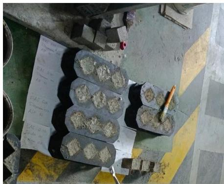
Gambar 3. 57 Mendingkan cetakan hingga mengeras
