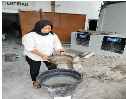
Gambar 3. 14 Menyaring agregat halus dengan saringan No.4
