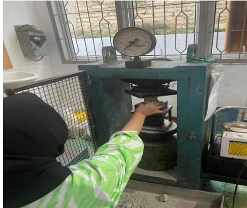
Gambar 3. 61 Melakukan pengujian kuat tekan
