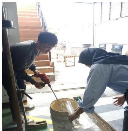
Gambar 3. 54 Memasukkan air kedalam adonan mortar
