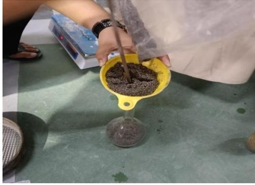
Gambar 3. 7 Memasukkan agregat kedalam piknometer
