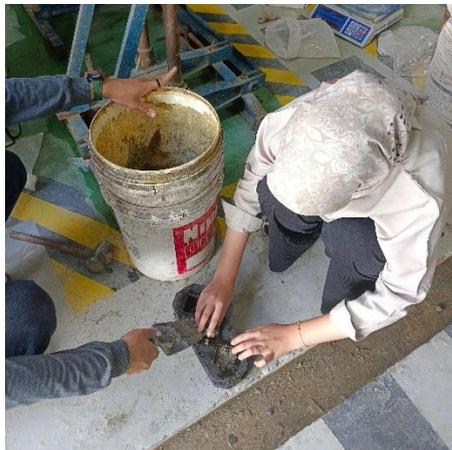
Gambar L.5 Pembuatan Benda Uji Mortar
