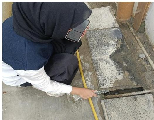
Gambar 3. 6 Membuang air dari piknometer
