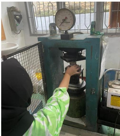
Gambar L.8 Pengujian Kuat Tekan Mortar
