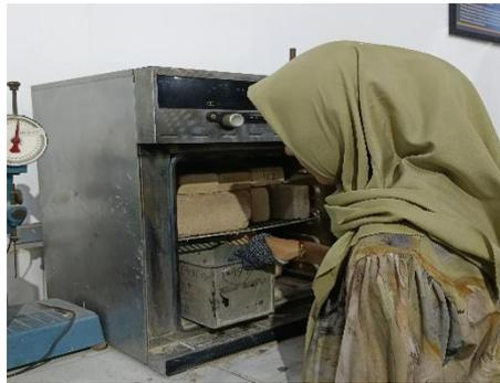
Gambar 3. 24 Memasukkan sampel bahan kedalam oven
