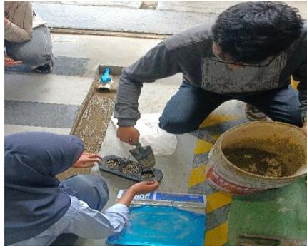
Gambar 3. 55 Menuangkan adonan kedalam cetakan kubus
