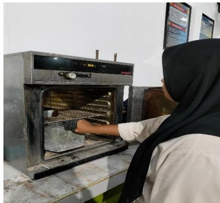
Gambar 3. 11 Memasukkan wadah berisi sampel bahan kedalam oven
