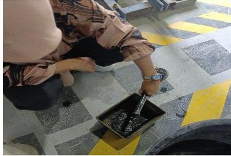
Gambar 3. 10 Mengeluarkan sampel bahan dari piknometer kedalam wadah
