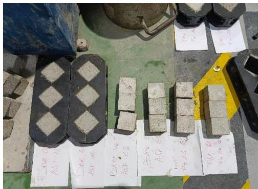
Gambar 3. 46 Mendingkan cetakan hingga mortar mengeras
