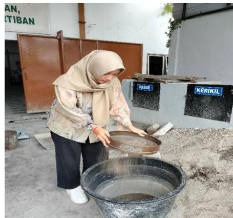
Gambar 3. 20 Mengayak agregat halus dengan saringan No.4
