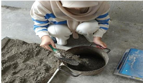
Gambar 3. 30 Memasukan sampel bahan kedalam wadah baja
