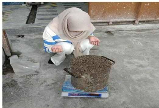
Gambar 3. 32 Menimbang wadah baja berisi agregat halus
