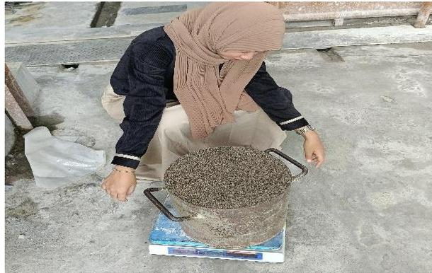
Gambar 3. 38 Menimbang wadah baja berisi agregat halus
