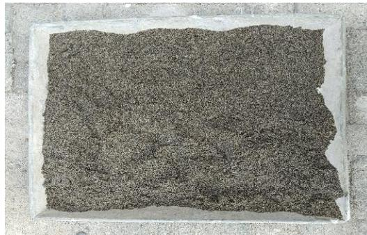
Gambar 3. 3 Agregat halus yang dikeringkan
