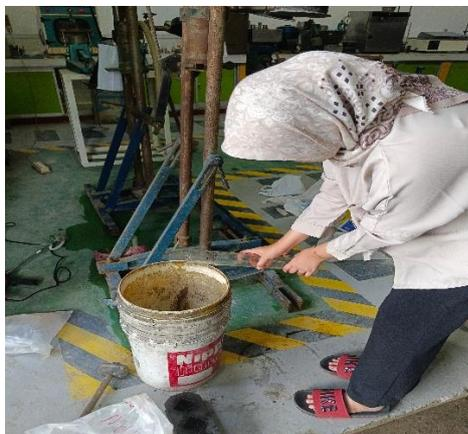
Gambar 3. 43 Memasukkan air kedalam adonan mortar
