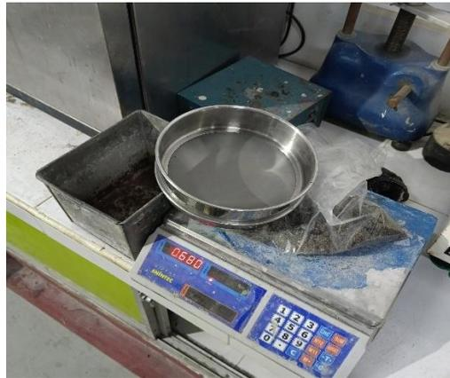
Gambar 3. 19 Alat dan bahan pengujian kadar lumpur
