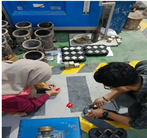
Gambar 3. 47 Membuka cetakan mortar
