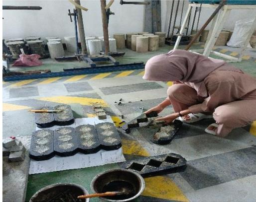
Gambar 3. 58 Membuka cetakan mortar
