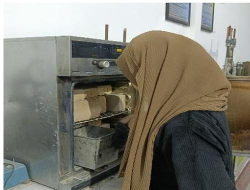
Gambar 3. 25 Mengeluarkan sampel bahan dari oven
