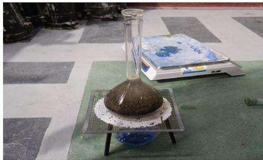
Gambar 3. 8 Memanaskan piknometer yang berisi agregat halus dan air
