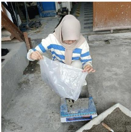
Gambar L.3 Pengujian Kadar Air Agregat halus
