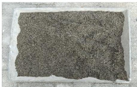
Gambar 3. 28 Agregat halus untuk pengujian berat isi
