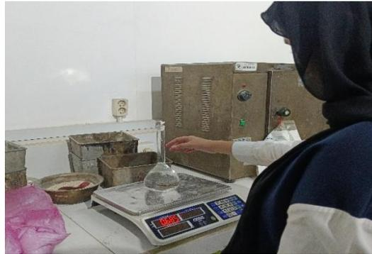
Gambar 3. 5 Menimbang piknometer yang berisi air
