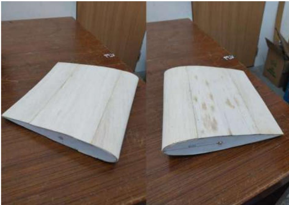
Gambar 4.16 Hasil fabrikasi model NACA 0012 dan NACA 0018
