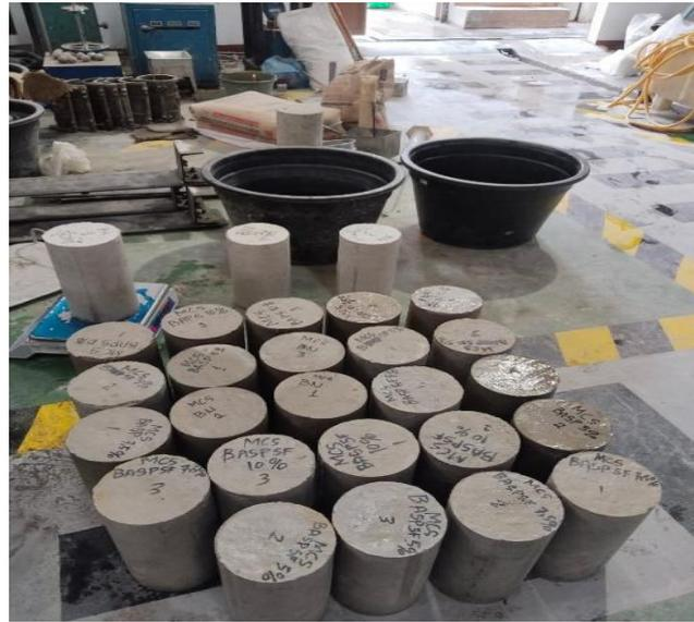
Gambar. 7. 11. Pengangkatan Beton Setelah Perendaman
