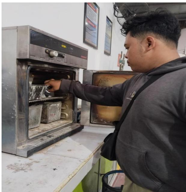
Gambar. 7. 3. Memasukan Agregat Kedalam Oven
