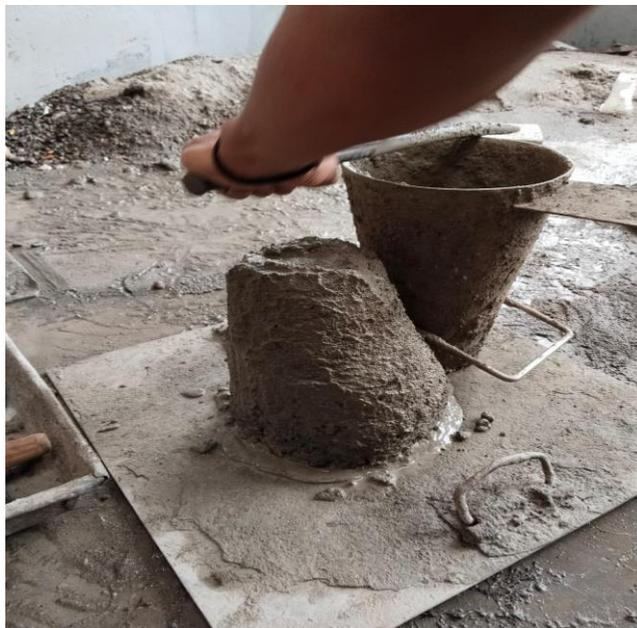
Gambar. 7. 8. Pengujian Slump Test
