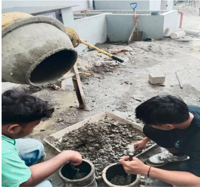
Gambar. 7. 7. Memasukan Beton Ke dalam cetakan
