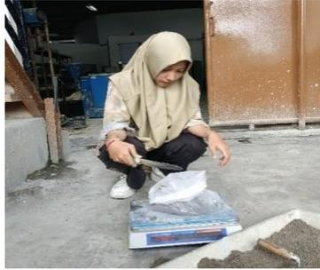
Gambar 3.46: Menimbang agregat halus.
