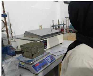
Gambar 3.50: Menimbang agregat setelah dioven.
