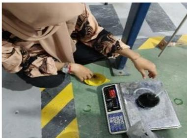
Gambar 3.68: Timbang piknometer berisi sampel ATK.
