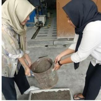
Gambar L. 1: Pengujian berat isi agregat halus.
