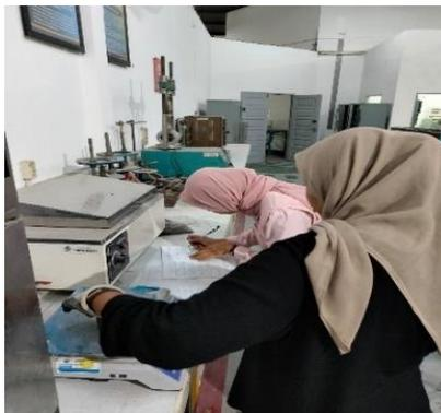
Gambar 3.91: Mengeluarkan mortar dan lalu ditimbang.
