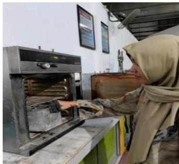
Gambar 3.48: Memasukkan benda uji ke oven.
