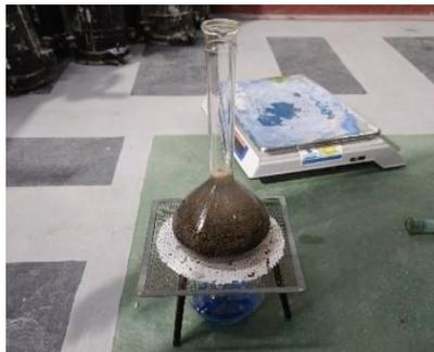
Gambar 3.32: Memanaskan piknometer berisi air serta agregat halus.
