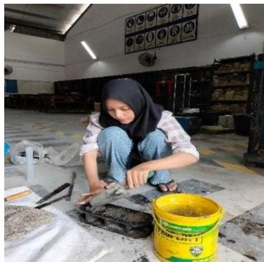
Gambar 3.99: Menuang adonan mortar kedalam cetakan.
