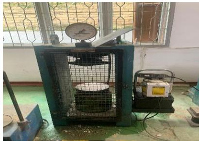
Gambar 3.11: Mesin pengujian kuat tekan.
