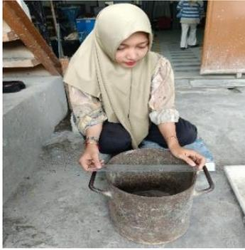
Gambar 3.54: Mengukur dimensi wadah baja.
