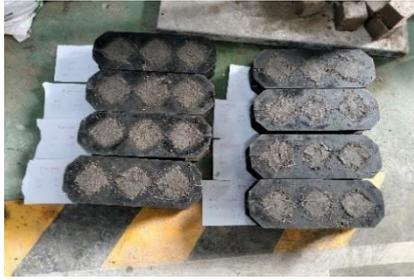
Gambar 3.86: Mendingkan cetakan mortar hingga mengeras.
