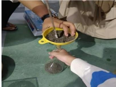
Gambar 3.31: Memasukkan agregat halus kedalam piknometer.
