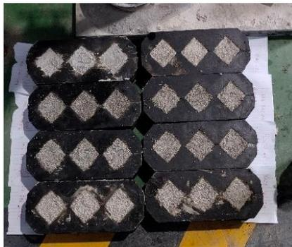
Gambar 3.102: Mendingkan cetakan mortar hingga mengeras.
