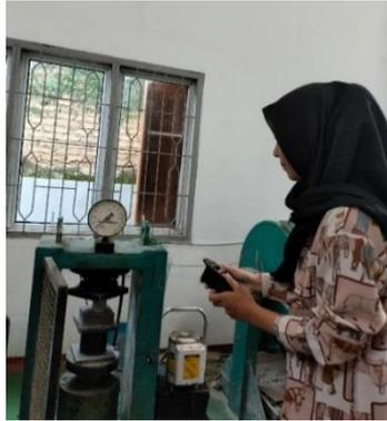
Gambar 3.92: Melakukan pengujian kuat tekan.
