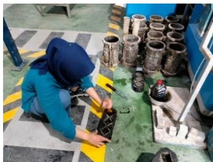
Gambar 3.82: Oles cetakan secara merata.
