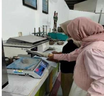
Gambar 3.107: Timbang mortar setelah selesai dioven.
