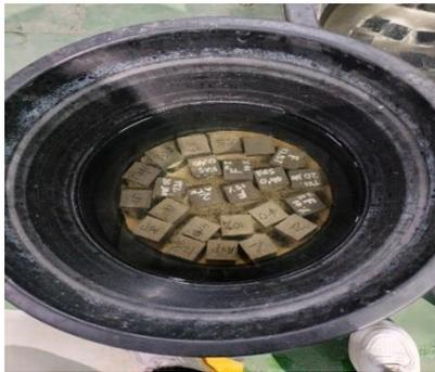
Gambar L. 6: Pembuatan benda uji mortar.
