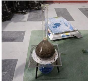
Gambar L. 2: Pengujian berat jenis agregat halus.
