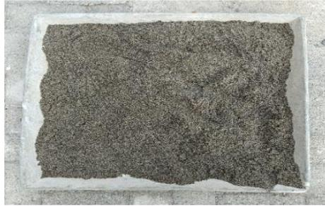
Gambar3.28: Mengeringkan agregat halus.
