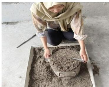
Gambar 3.59: Meratakan benda uji dengan mistar perata.
