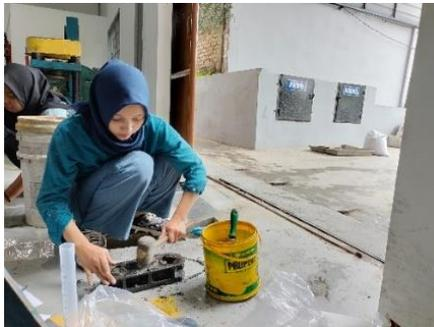
Gambar 3.84: Pemadatan mortar menggunakan palu karet.
