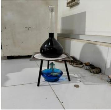
Gambar 3.69: Panaskan piknometer yang berisi sampel ATK.
