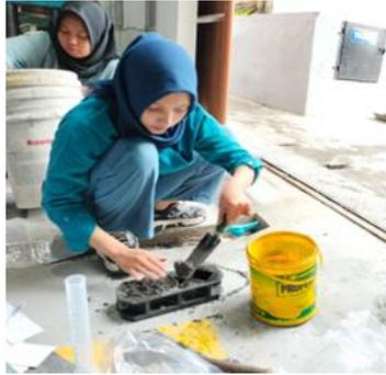
Gambar L. 5: Pembuatan benda uji mortar.
