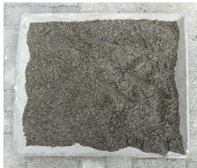
Gambar 3.52: Meletakkan agregat ke dalam pan.
