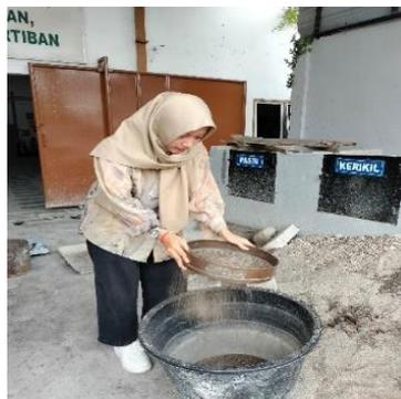
Gambar 3.45: Diayak agregat halus saringan no.4.
