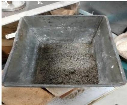
Gambar 3.35: Mengeluarkan agregat halus ke wadah.
