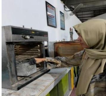
Gambar 3.42: Mengeringkan agregat halus ke dalam oven.
