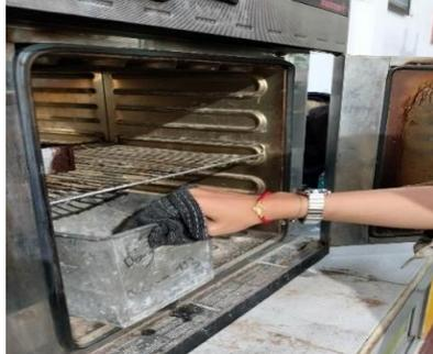
Gambar 3.49: Mengeluarkan agregat halus setelah dioven.
