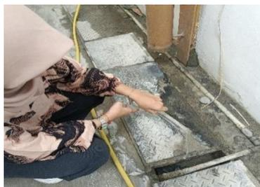
Gambar 3.30: Membuang air dari piknometer.
