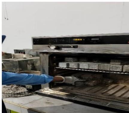
Gambar 3.106: Masukkan mortar kedalam oven.
