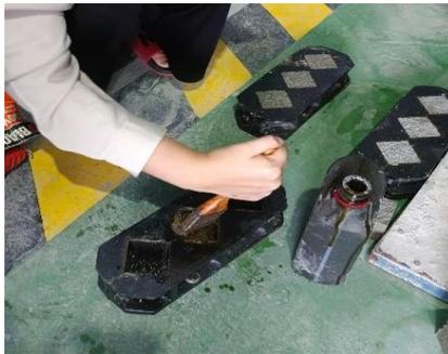
Gambar 3.98: Mengoles cetakan secara merata.
