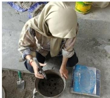
Gambar 3.58: Memasukkan benda uji dan menusuk dengan tongkat pematik.
