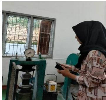
Gambar L. 7: Pengujian kuat tekan mortar.
