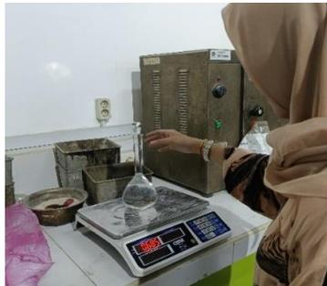
Gambar 3.29: Menimbang piknometer terisi air.
