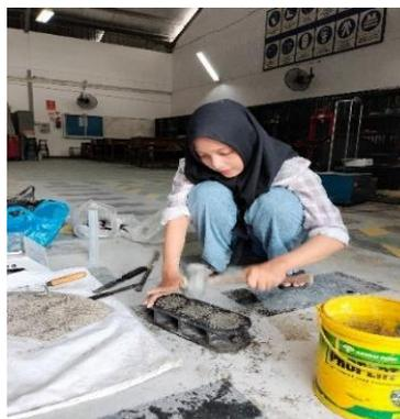
Gambar 3.100: Memadatkan mortar menggunakan palu karet.
