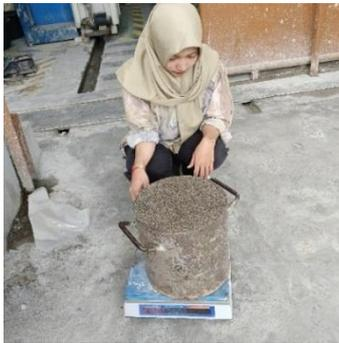
Gambar 3.63: Menimbang wadah yang berisi agregat halus.
