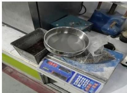
Gambar 3.38: Menyiapkan bahan pengerjaan kadar air agregat halus.
