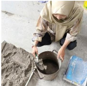
Gambar 3.55: Isi agregat kedalam wadah besi.
