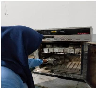
Gambar 3.90: Masukkan mortar kedalam oven.
