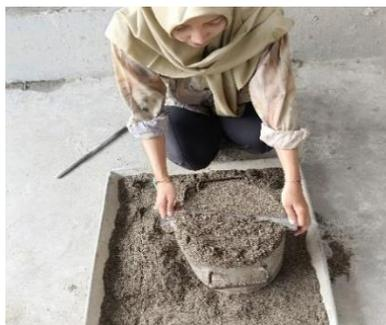
Gambar 3.62: Meratakan benda uji dengan mistar perata.
