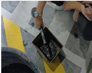
Gambar 3.73: Tuangkan isi piknometer ke wadah.
