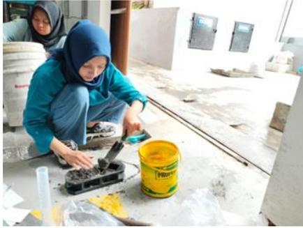
Gambar 3.83: Menuangkan adonan mortar kedalam cetakan kubus.
