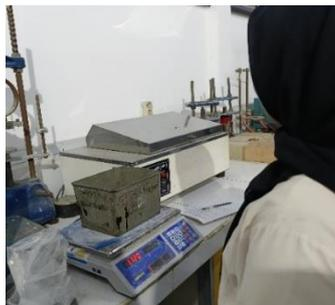
Gambar 3.43: Menimbang agregat halus setelah dioven.
