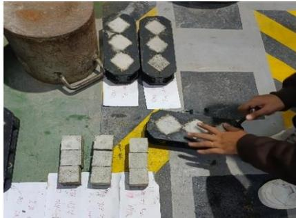
Gambar 3.87: Membuka cetakan mortar.
