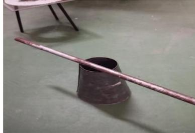
Gambar 3.7: Cetakan kerucut pasir dan tongkat pemadat.
