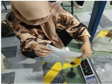
Gambar 3.67: Masukkan sampel ATK ke piknometer.
