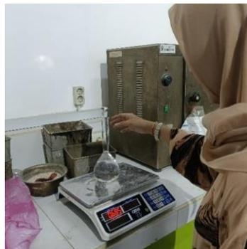
Gambar 3.65: Timbang piknometer berisi air.
