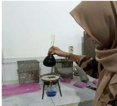
Gambar 3.70: Angkat piknometer dan digoyangkan mengeluarkan gelembung udara.
