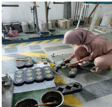
Gambar 3.103: Membuka cetakan mortar.
