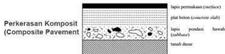
Gambar 2.3: Struktur Perkerasan Komposit Jalan (Surahman 2017)
