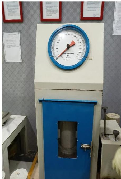
Gambar L – 8: Proses Pengujian Kuat Tekan Pada Benda Uji.
