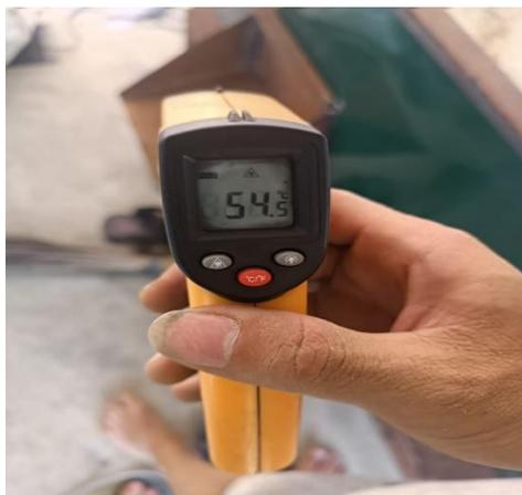
Gambar 4. 11 suhu pada perbandingan sekam 25:tempurung75
