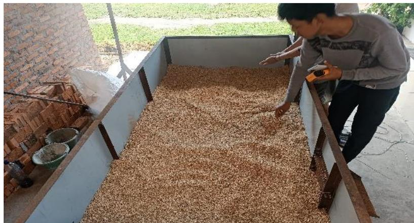
Gambar 4. 4 Pengujian Pengeringan Gabah
