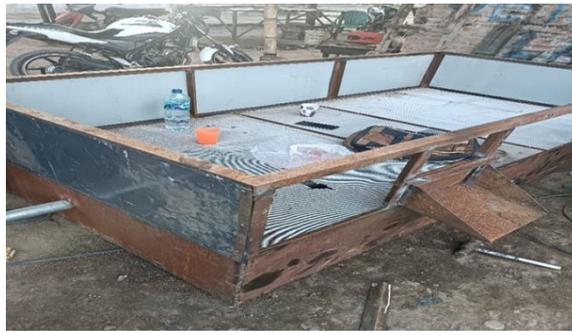
Gambar 4. 1 Rangka Alat Pengering Padi
