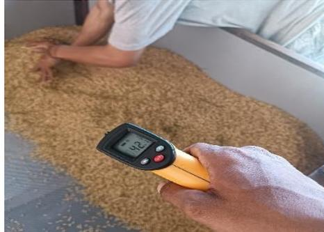
Gambar 4. 10 suhu pada perbandingan tempurung 25:sekam 75
