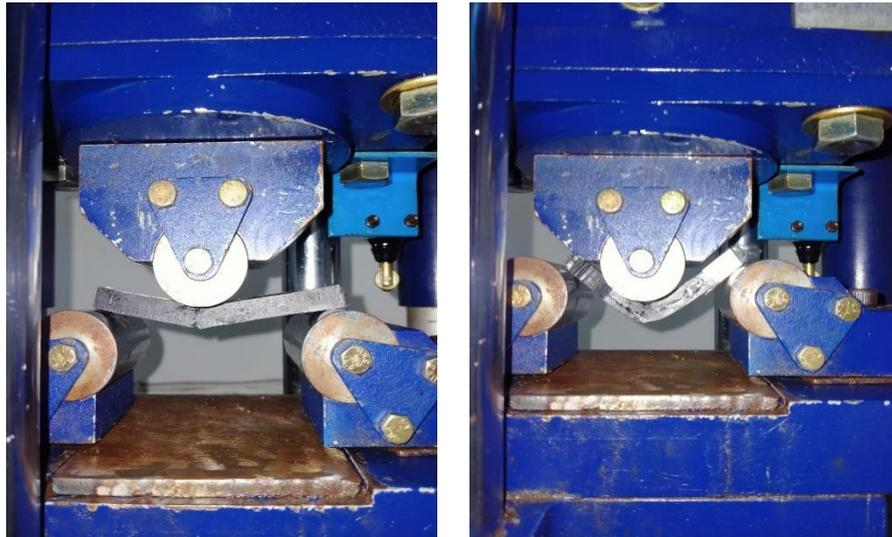
Gambar 4.4. Hasil uji teka pada specimen 3 (80% HDPE-20% KA)
