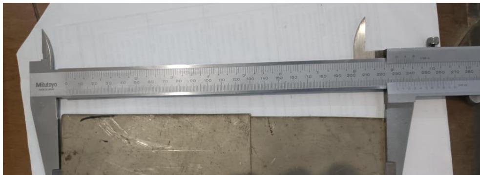
Gambar 4.13 Pengukuran ulang spesimen sebelum di uji
