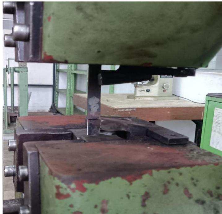
Gambar 4.15 Spesimen uji di letakan pada bais
