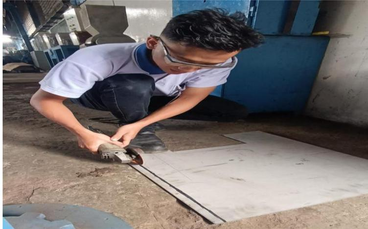
Gambar 4.2 Proses pemotongan spesimen uji
