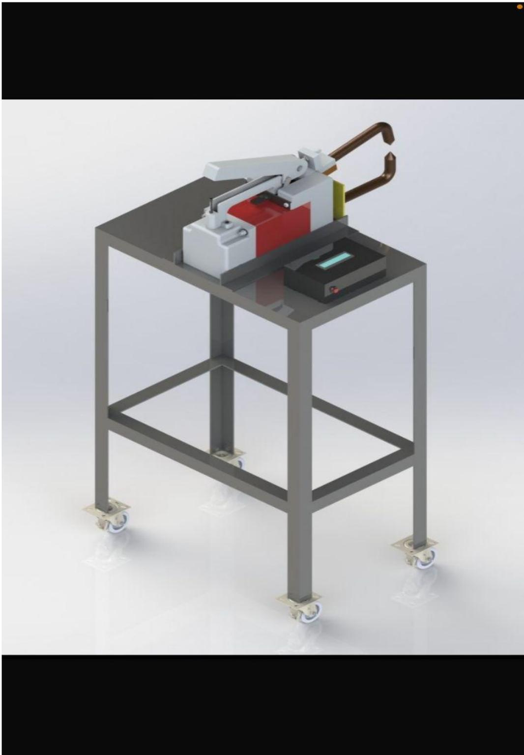
Gambar 3.13 Desain Mesin las titik
