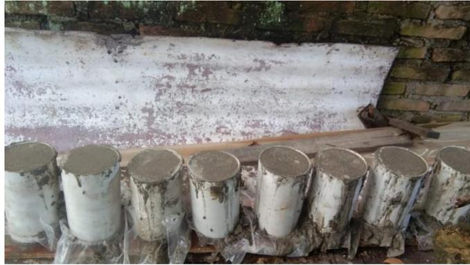
Gambar 3.7. Hasil Cetakan Spesimen Dari Pipa Paralon
