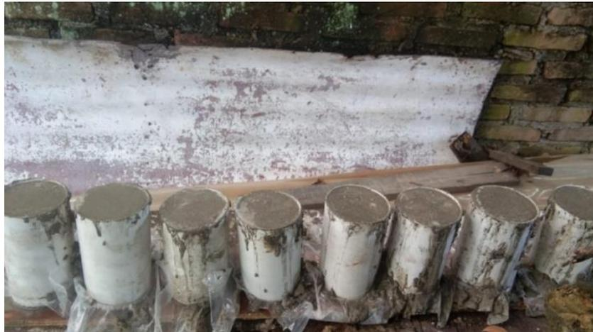
Gambar 4.6. Pencetakan Spesimen
