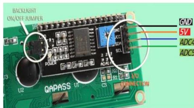
Gambar 2.13. Konfigurasi PIN LCD
