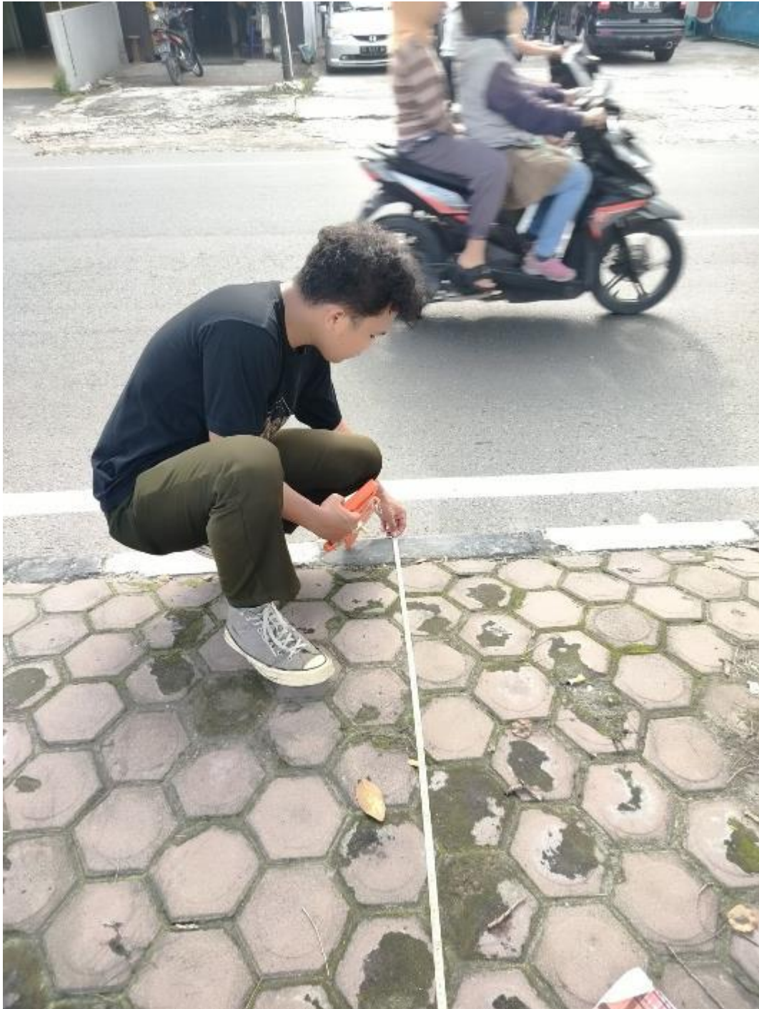
Gambar L.2: Pengukuran Lebar Median Jalan
