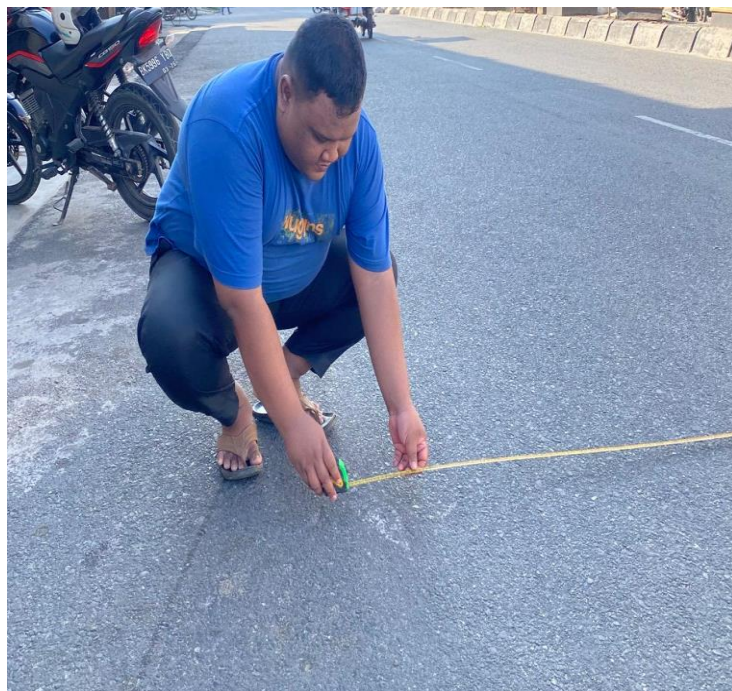
Gambar L.4 Mengukur lebar jalan
